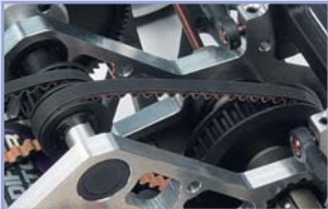
Diffzahnrad 34Z / Freilaufriemenrad 16Z
