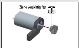
3. Montieren Sie die Motorbefestigung am M18 Chassis und stellen Sie das Zahnflankenspiel ein.
