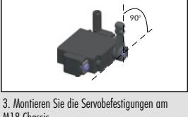
3. Montieren Sie die Servobefestigungen am M18 Chassis.
