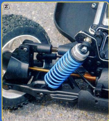
1/ Nouvelles rotules de direction avant avec système anti-déchappage intégré
