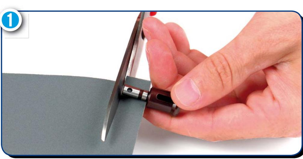
1. Verwenden Sie ultrafeines Schleifpapier und schneiden Sie es in Streifen mit der gleichen Breite wie der Schaft des Diffausgangs.
