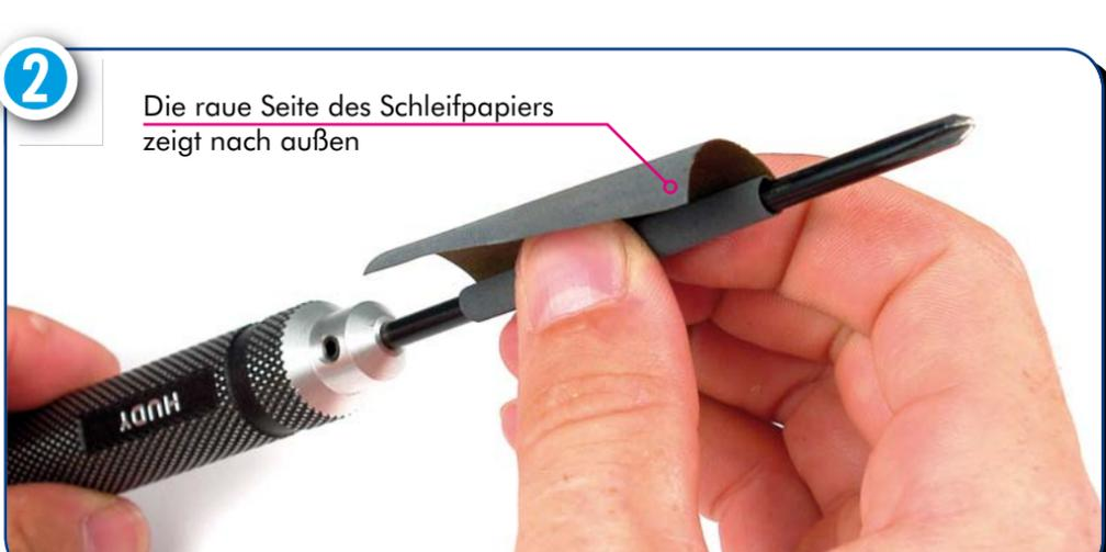
Rollen Sie das Schleifpapier mit der rauhen Seite nach außen auf eine dünne Welle, z. B. einen Schraubendreher.
