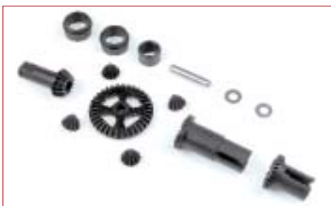
Despiece de uno de los dos diferenciales de piñones cónicos con que está equipado el M18.
