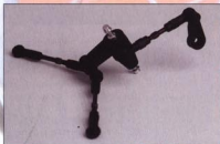
Direct aan de servosaver zijn de stuurslangen bevestigd.
