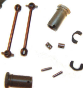
Particolare del portamozzo posteriore con relativo omocinetico.
