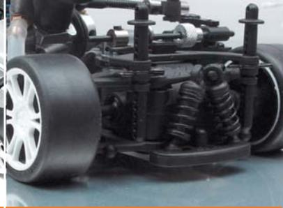
Einteilige Kunststoffradioplatte ermöglicht schnellen Zugriff auf die RC-Komponenten
