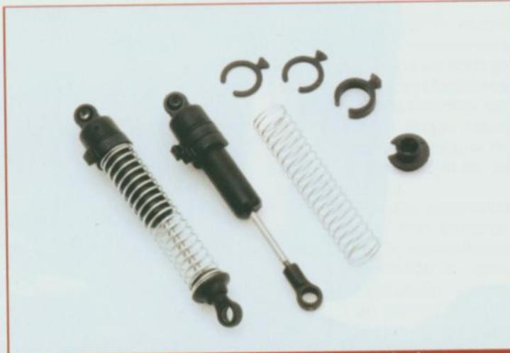
Los amortiguadores disponen de dos tipos diferentes de pistones, membrana de compensación de volumen, precarga ajustable, etc.
