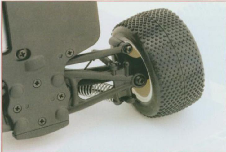
El M18T se encuentra dotado de transmisión mediante cardanes en las cuatro ruedas.
