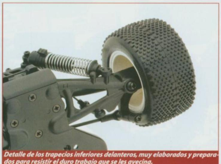
*Detalle de los trapecios inferiores delanteros, muy elaborados y preparados para resistir el duro trabajo que se les avecina.*
