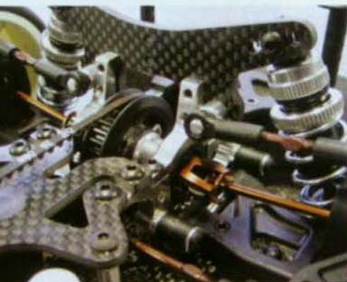
Kardans, Abtriebe und Rechts/Links-gewinde aus Hudy-Federstahl
