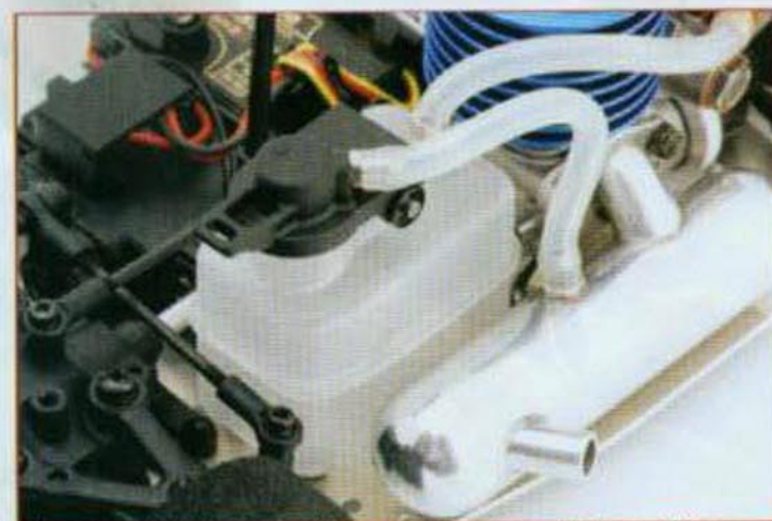
El mini-depósito de combustible, con 30 cc de capacidad y con filtro interno.
