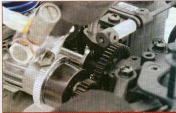
Primer plano del conjunto de la campana de embrague y la corona, con posibilidad de efectuar un "micro-ataque".
