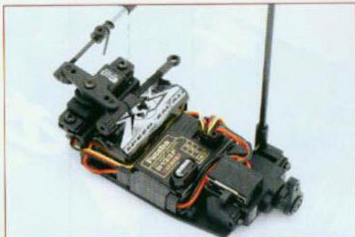
Es posible extraer cómodamente la bandeja de radio del chasis, con sólo retirar 4 tornillos.
