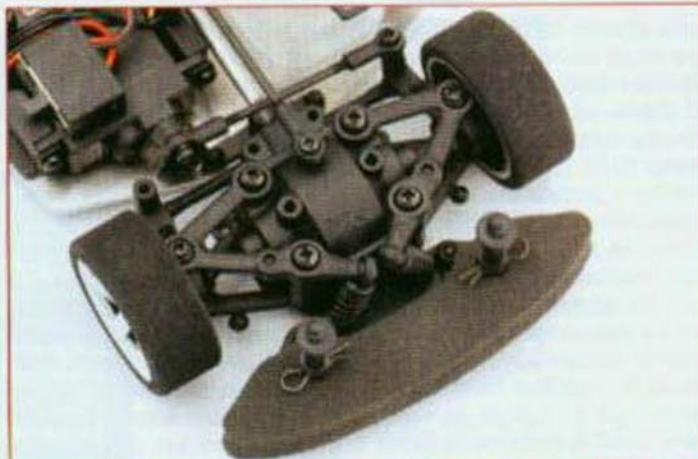
Detalle del tren delantero: trapecios, amortiguadores, etc. todo nos recuerda a un coche grande.
