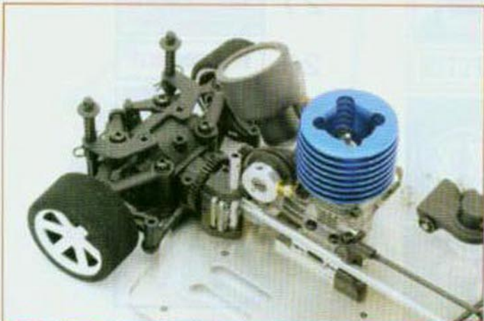
El XRay NT18 contempla una transmisión a las cuatro ruedas mediante un palier central.
