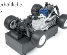
Einteilige Kunststoffradioplate ermöglicht schnellen Zugriff auf die RC-Komponenten
