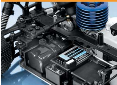
Einfacher Zugriff auf das hintere Gestänge ermöglicht schnelle Einstellungen zur Feinabstimmung
