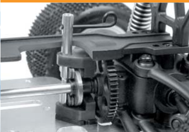
Lasergeschnittene, von Hand geschliffene Bremscheibe für ein dosierbares Bremsen aller vier Räder
