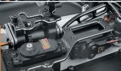
Radioplate und Diffplatte aus 7075 T6 Aluminium
