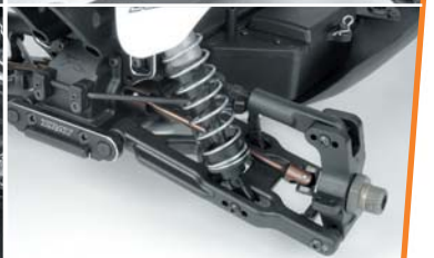
Neue hintere Aufhängungsgeometrie
