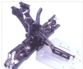
리어 블록을 새사에 장착 모습.
