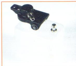
Il serbatoio è un vero gioiello, proprio per le dimensioni contenute e per l'accuratezza con cui viene realizzato. Sul tappo è addirittura presente la presa a pressione.
