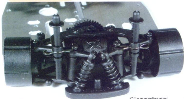
Gli ammortizzatori sono ovviamente privi della parte idraulica e si differenziano solo per l'anellino di precarico presente su quelli anteriori. La diversa rigidità è subito evidente.
