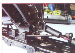
Gli attacchi per il recupero dinamico del camber posteriore.
