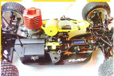
Il castelletto motore. La piastra radio e la piastra centrale.
