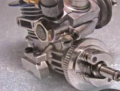
montáži motoru nastavíme zubovou vůli. Trochu nám dalo zabrat nastavení axiální vůle pastorku, ale za použití podložek vlastní výroby se nám to nakonec podařilo. Myslím, že bychom preciznost při montáži tak malého modelu neměli podcenit. Axiální vůle samotného klikového hřidele se sice po dotažení setrvačníku na kužel změnila, ale i tak si myslím, že by mohla být menší. Motor osadíme vyfukem, který je přitázen přímo na
