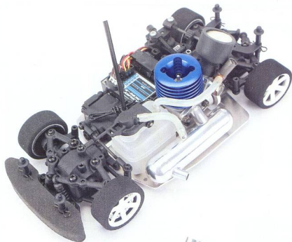
Die "Quick release" Radioplate kann schnell aus dem Chassis genommen werden – Reinigung kein Problem
