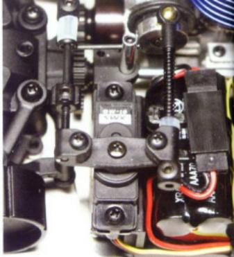
Das Gasservo aus dem XRAY-Electric-Pack ist, ebenso wie das Lenkservo, mit einem Metallgetriebe ausgestattet und optimal angepasst. Zu beachten ist das schnörkellose und direkte Gas-/Bremsgestänge
