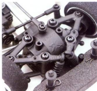
Beide Antriebseinheiten sind mit einer vollwertigen Einzelradaufhängung ausgestattet. Die Einstellmöglichkeiten beschränken sich allerdings auf den Ausfederweg. Den Schutz der Vorderachse gewährleistet ein kleiner Schaumstoff-Rammer
