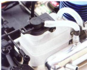
Der Tank des NT18 könnte eine geschrumpfte Version des aus dem XB8 sein. Er verfügt ebenfalls über einen Sinterfilter und einen Schnelltankverschluss, sein Fassungsvermögen beträgt aber nur 30 Kubikzentimeter
