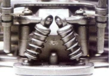
Bei den Dämpfern handelt es sich um ein simples Kunststoffgehäuse mit aufgesetzter Feder. Für einen richtigen Öl- oder Reibungsdämpfer fehlt schlichtweg der Platz
