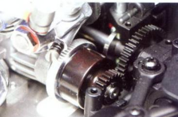
Für die Kraftübertragung zeichnet sich die Kombination aus Zweibackenaluminiumkupplung und Stahlglocke verantwortlich. Die Verarbeitung der Elemente ist trotz Miniaturisierung vorbildlich und einzigartig
