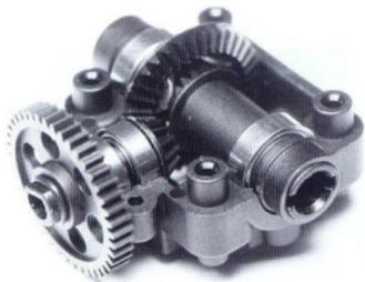
Beide Antriebszellen bestehen aus einem Gehäuse, in dem ein Kegeldifferential logiert. Selbstverständlich ist der komplette Antrieb kugelgelagert
