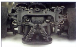
Einzelradaufhängung an doppelten Dreieckslenkern an Vorder- und Hinterachse.
