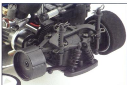
Frontrammer aus Moosgummi und Felgenträger mit 2 Positionen für unterschiedliche Spurbreite.
