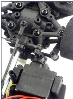
Liegendes Lenkservo mit Servosaver.
