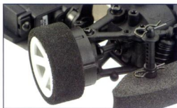
Einzelradaufhängung an doppelten Dreieckslenkern an Vorder- und Hinterachse.
