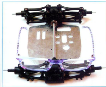
Gli snodi sferici ad altezza differenziale per il Caster anteriore.
