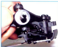
Notare l'angolo di Caster anteriore.
