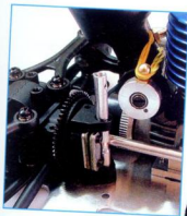
Il gruppo frenante e la corona centrale in acciaio.
