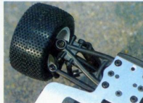
Le pincement sera réglable en remplaçant cette bielle fixe.
