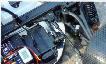
Le servo de direction est couché.
