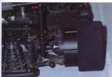
Beetje aparte constructie, maar het werkt wel. Velg waar weer een andere velg, maar nu met band, overheen geschoven wordt.
