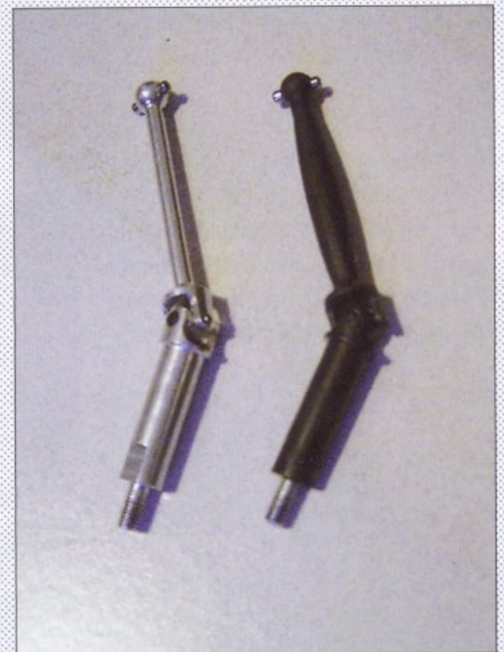
Die Tuning-Gelenkwelle im Vergleich zur Kunststoff-Gelenkwelle.
