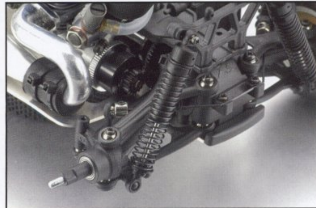
Kupplungsglocke, Ritzel und Hauptzahnrad aus Hudy-Federstahl. Bügelstabilisatoren vorne und hinten.
