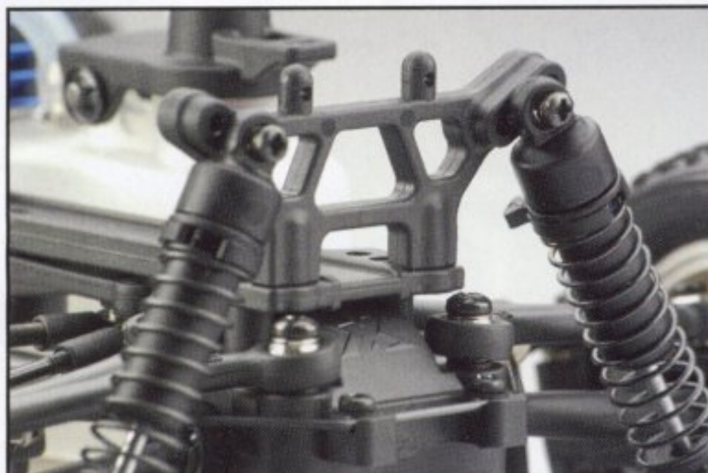
Dämpferbrücken mit drei Befestigungslöchern für die Dämpfer und Öldruckstoßdämpfer mit langem Federweg.
