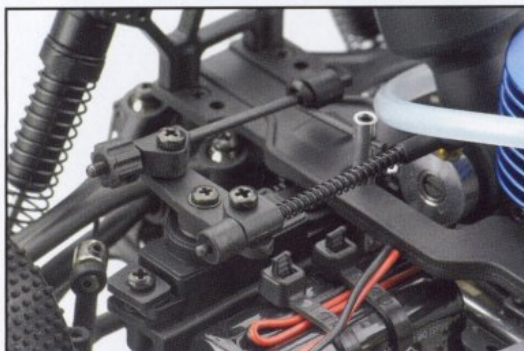
Vergaser- und Bremsanlenkung verstellbar und mit Drehgelenken.
