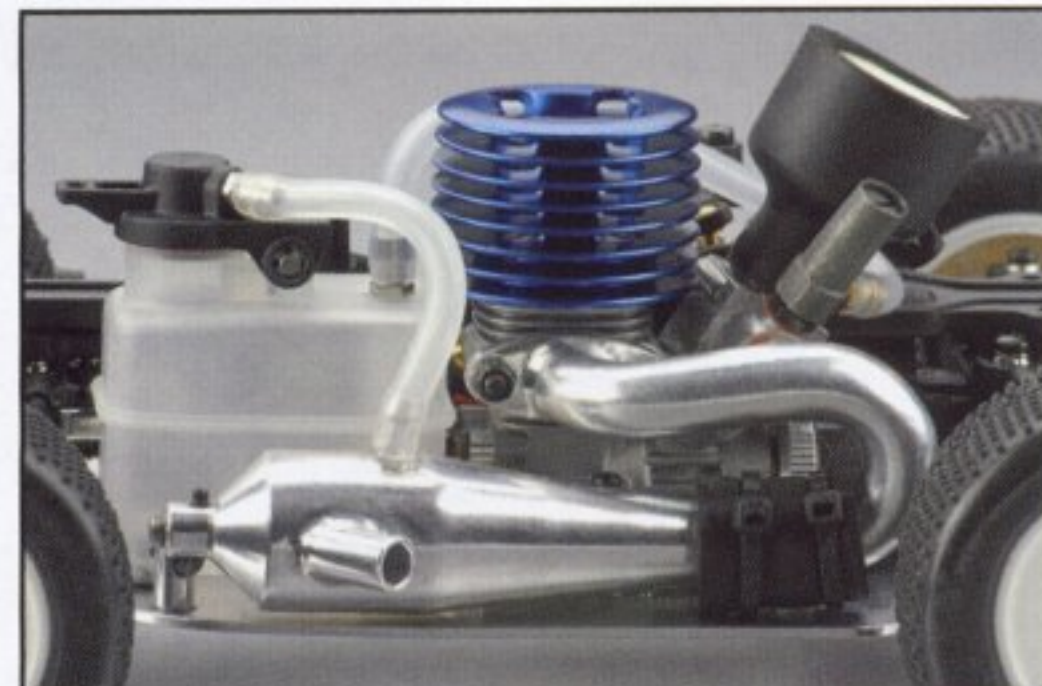
Schalldämpfer aus poliertem Alu. In den Motor passen Standard Glühkerzen.
