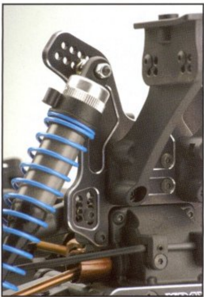
Zahlreiche Aufhängungspunkte für Dämpfer und Schubstangen.
