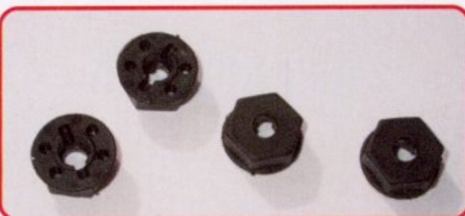
Contrairement à la T2 première du nom, le dernier-né slovaque opte ici pour des hexagones de roues en plastique.
