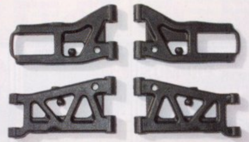
La T2R est équipée de quatre triangles inférieurs en version « Hard ».
