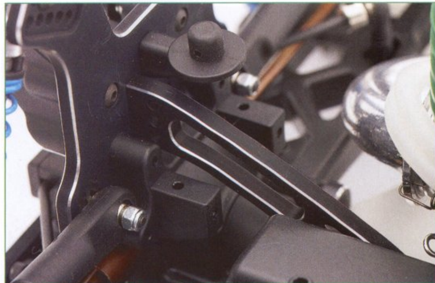
Detalle del espectacular rigidificador trasero del chasis que, siendo muy ligero, aporta una extraordinaria rigidez.
