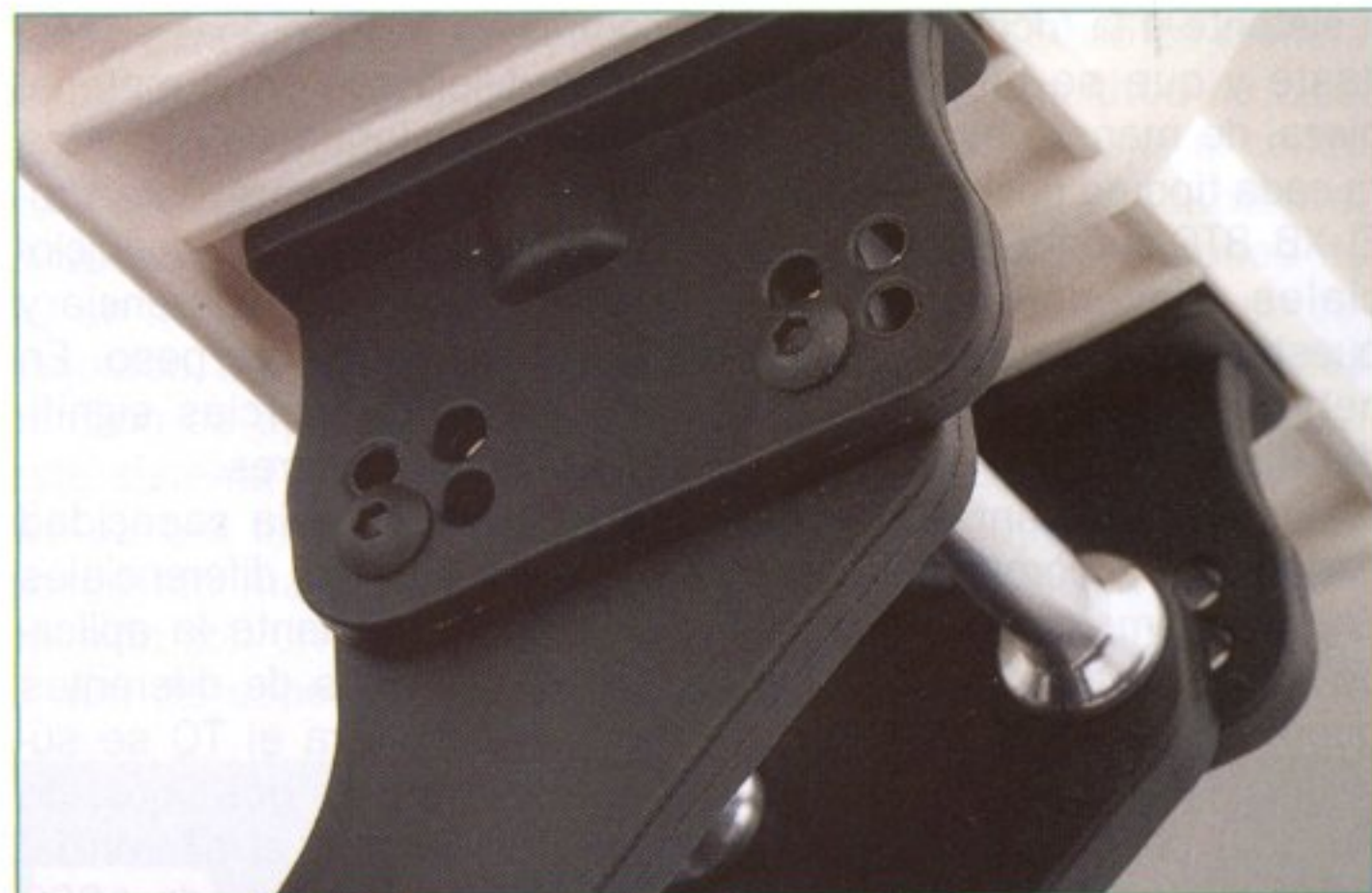
El soporte, de doble brazo, es muy resistente a los impactos y soporta un alerón de grandes dimensiones regulable en avance e inclinación.
