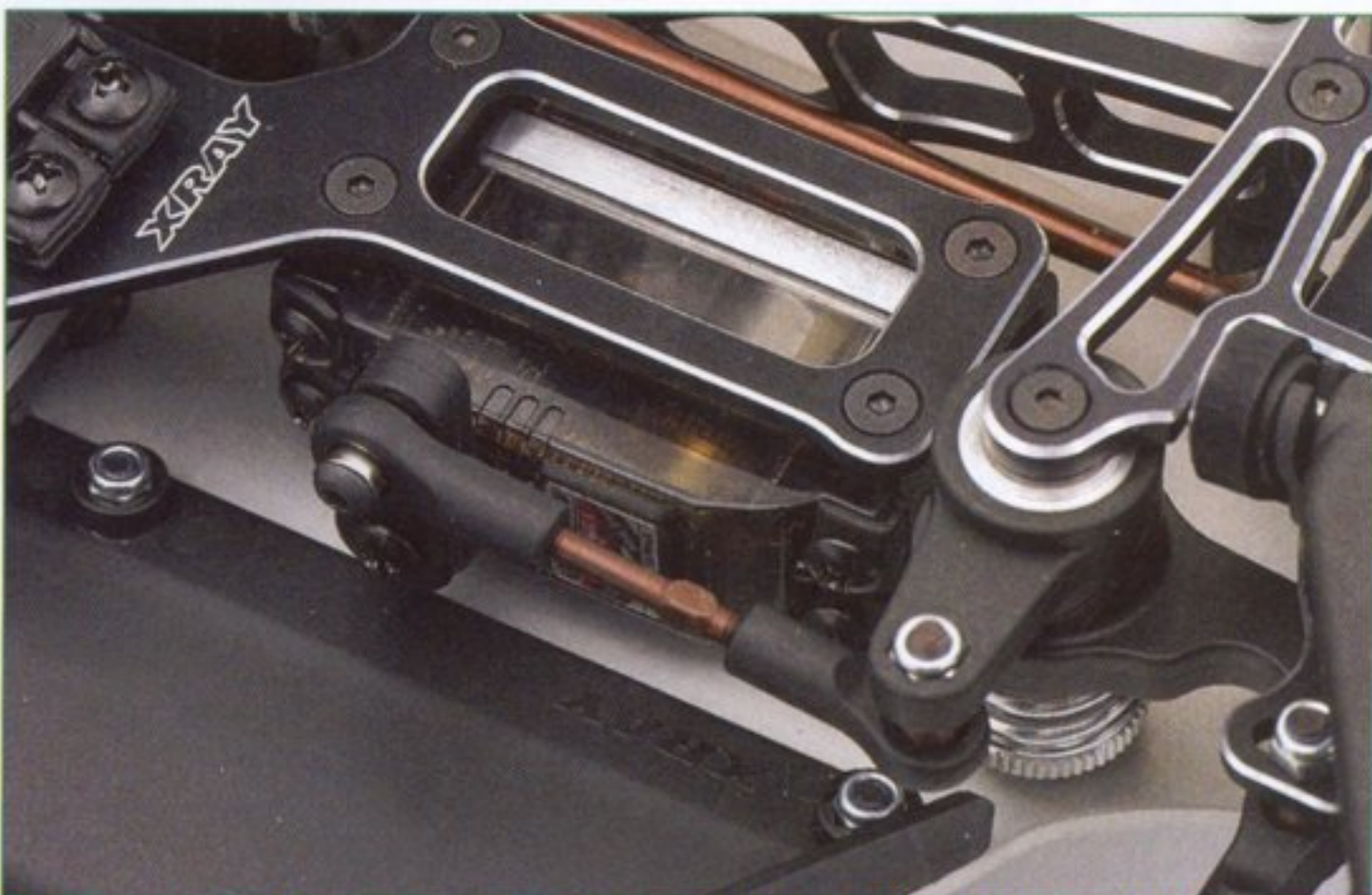
Siguiendo las últimas tendencias en mejora de la estabilidad, el servo de dirección se monta tumbado bajo la impecable bandeja de aluminio.
