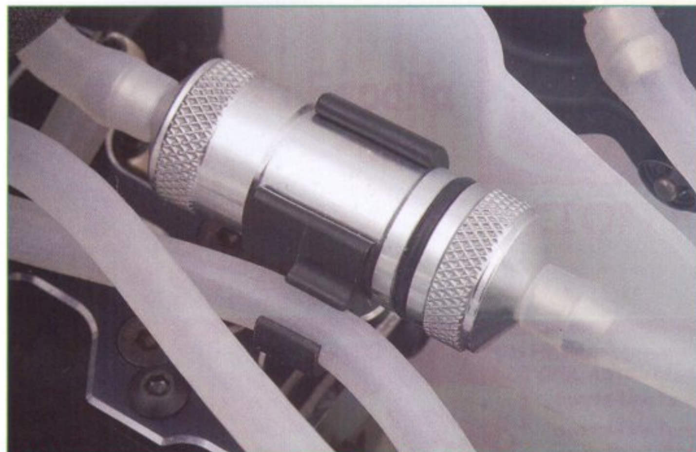
El kit incorpora un gran filtro de combustible de aluminio con su correspondiente soporte.
