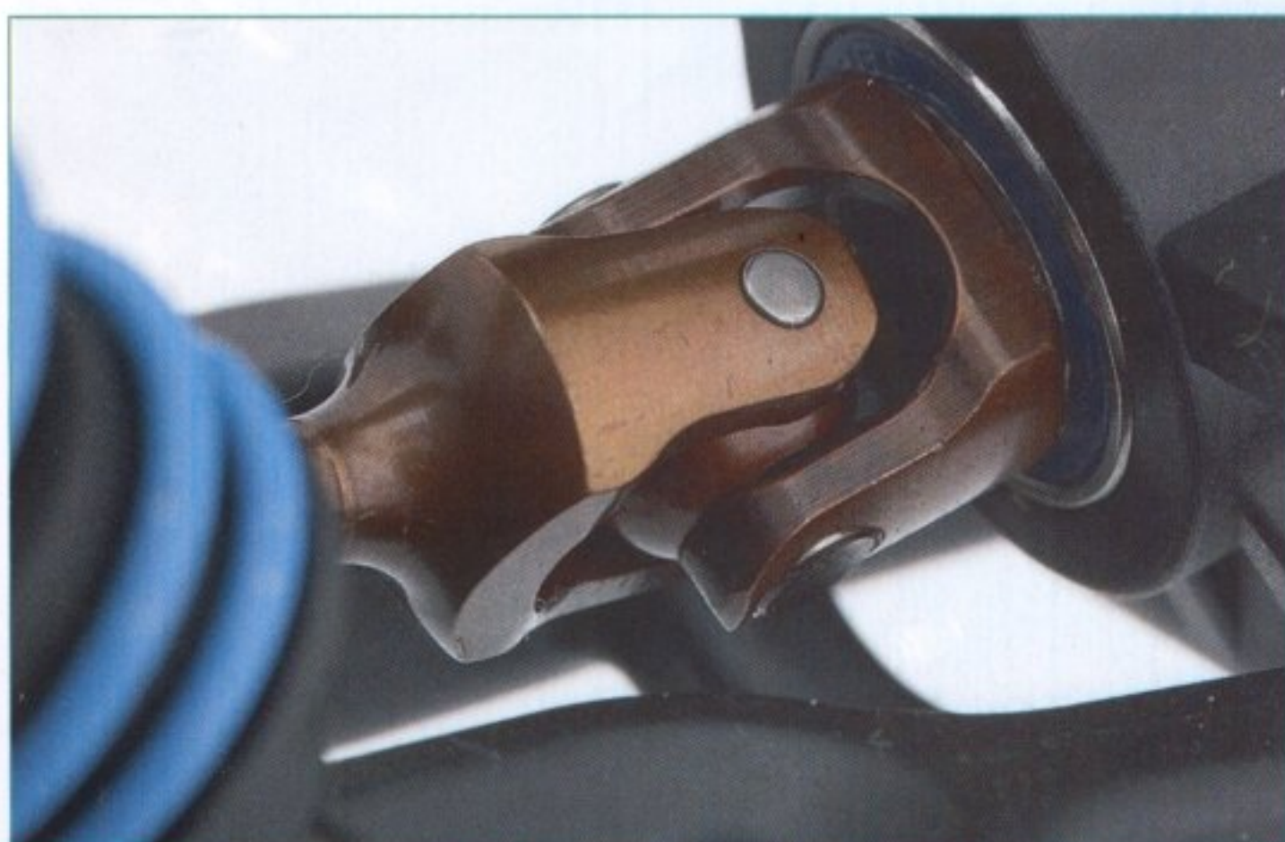
El XB8 TQ incorpora en todos los puntos, cardanes en aleación acero-aluminio y anodizados en color cobre.
