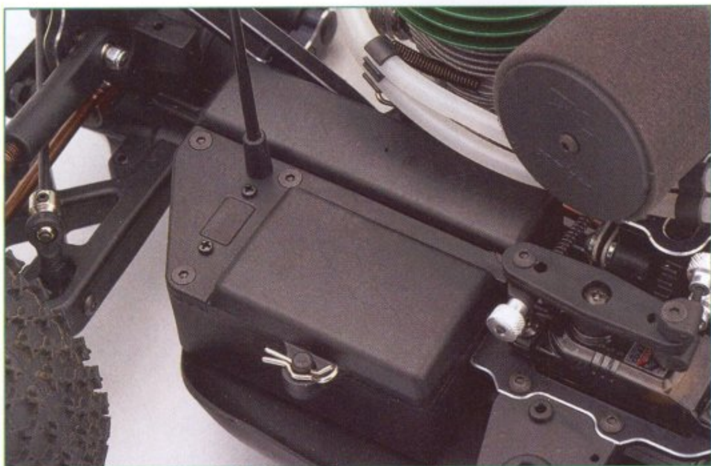
La caja del receptor aloja sin problemas cualquier tipo de receptor. Curiosa la caja para el pack de baterías que se coloca hacia el centro.
