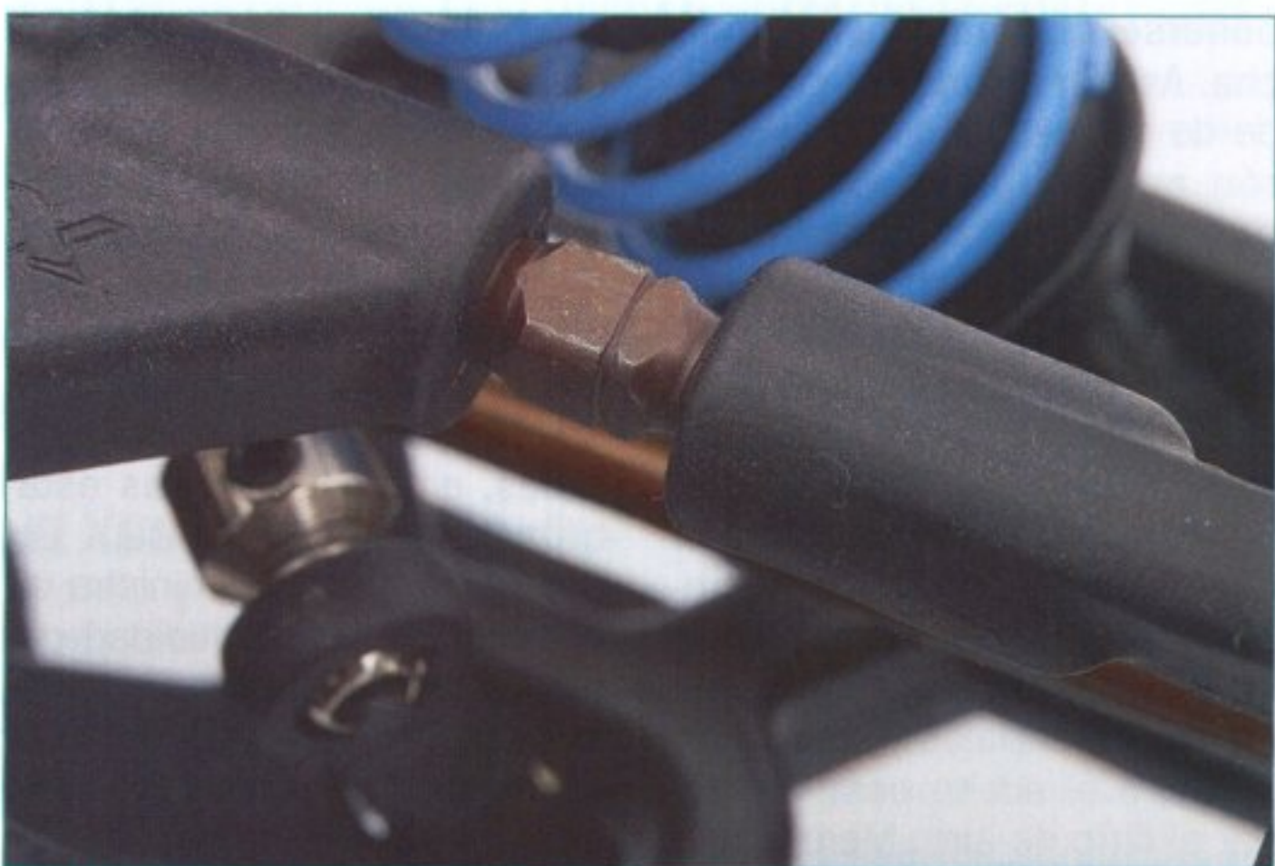
Todos los pasos inversos son de acero y de ajuste rápido.
