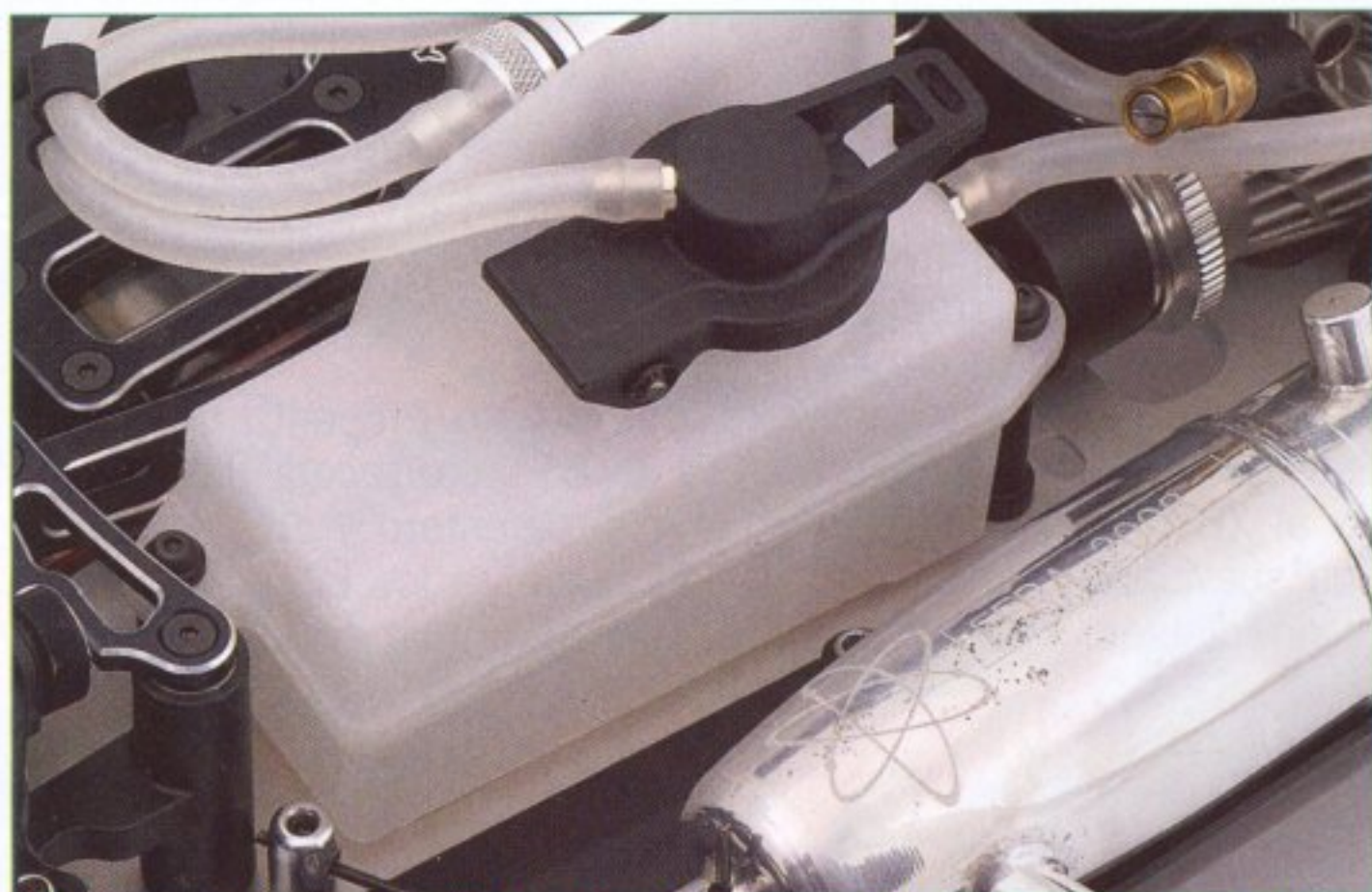
El depósito de combustible cubica 125 cc y con él queda garantizada la estanqueidad. Ahora viene 100% montado.
