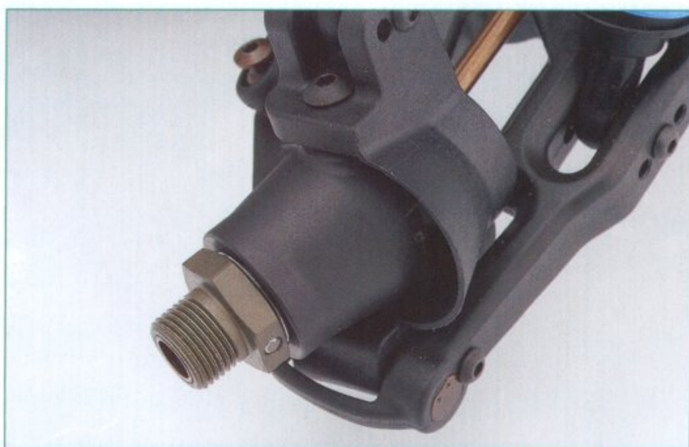
Las manguetas, aunque parecen de plástico, no lo son. Se trata de una aleación de gran dureza y ligereza.
