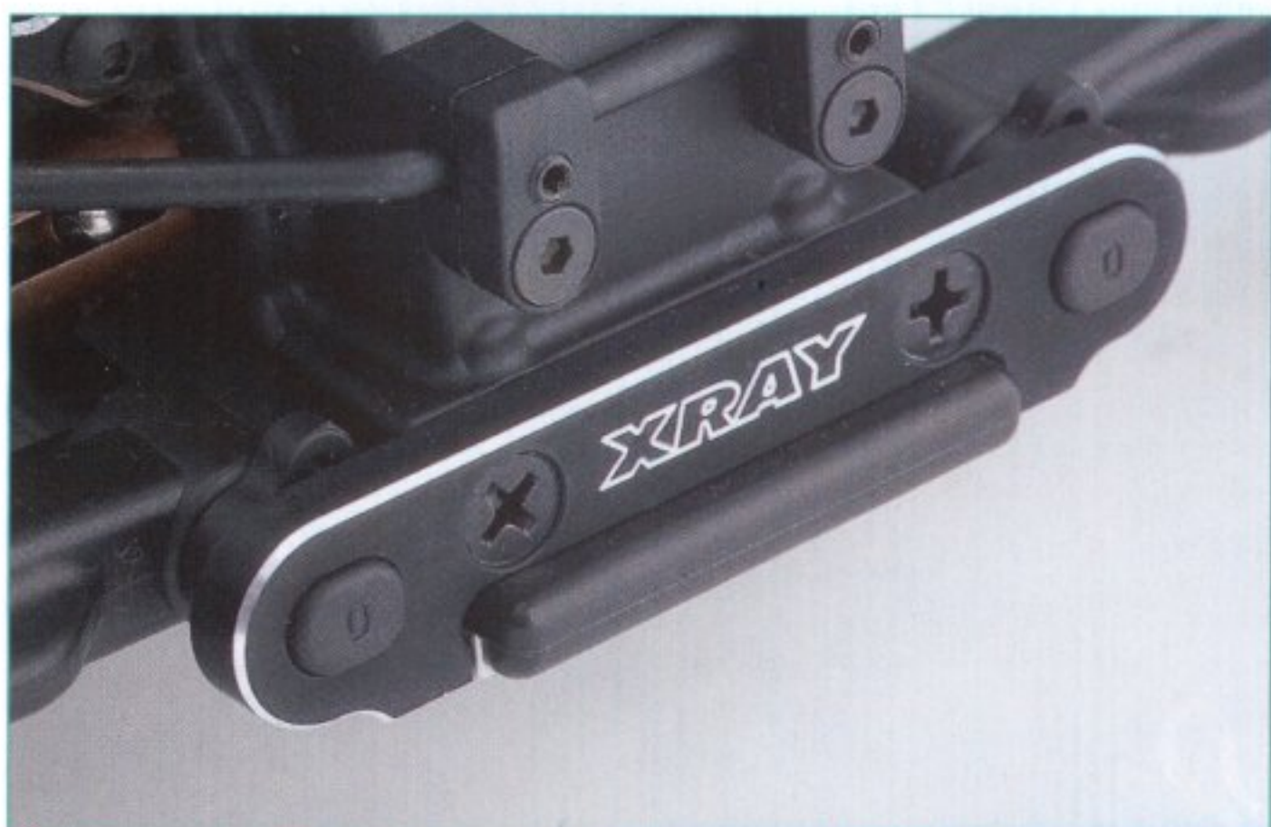
Para la regulación de la convergencia trasera el XB8 TQ presenta dos piezas exclusivas en elegante aluminio negro y plata.
