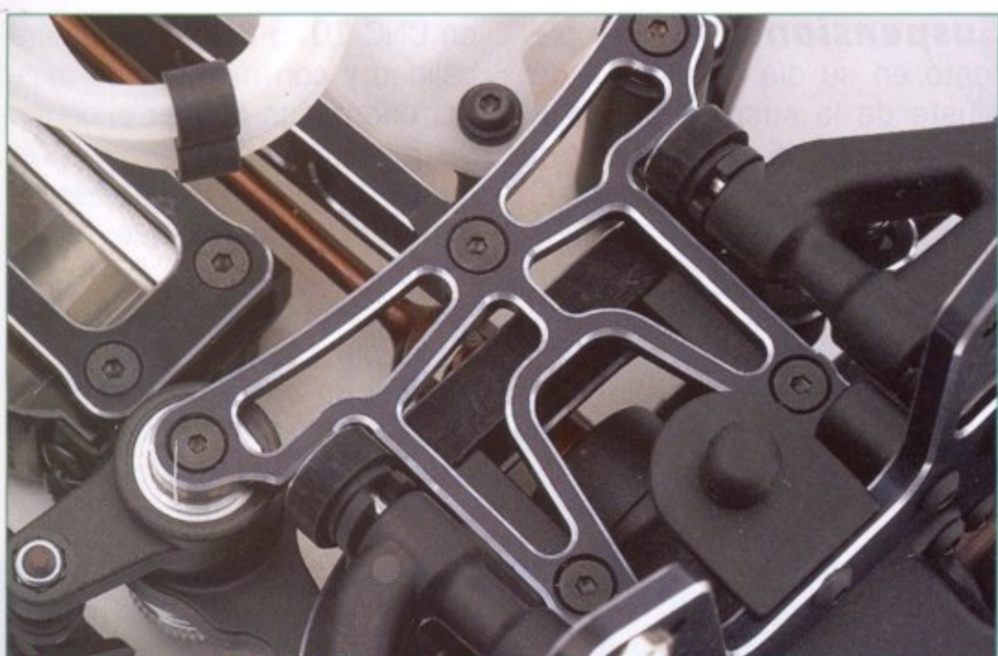
La "M" de sujeción de la dirección es de aluminio, de nuevo diseño y más ligera que la anterior.
