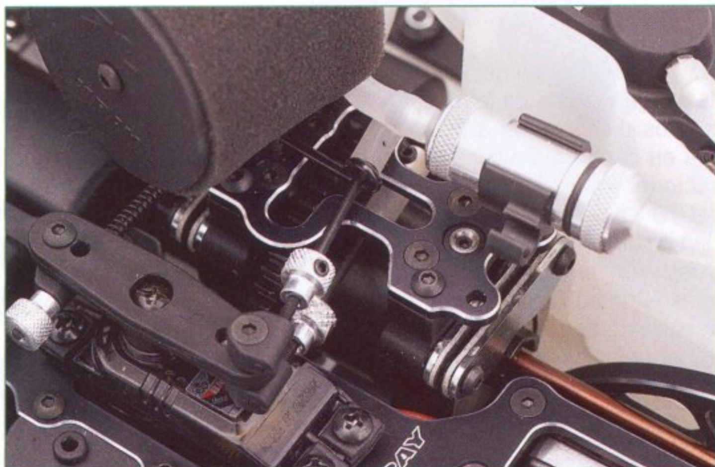
El soporte del diferencial central se desmonta en dos piezas, facilitando la extracción del diferencial para su mantenimiento.
