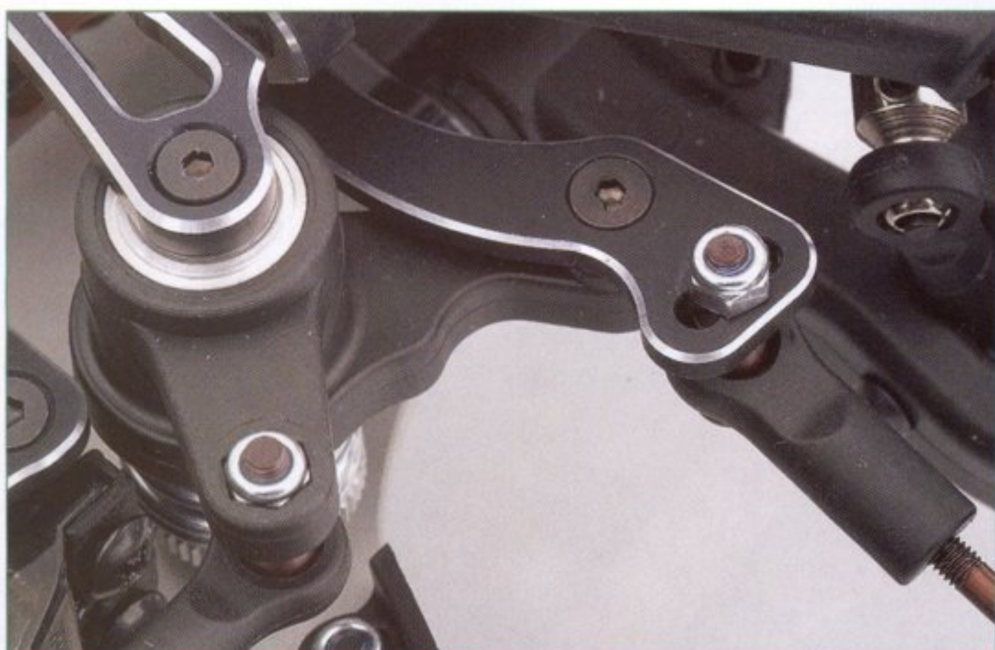
La pletina de dirección tiene tres posiciones de ajuste que permiten variar el Ackermann.
