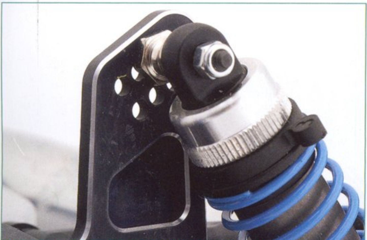
El soporte de los amortiguadores delanteros presenta hasta 8 puntos para el anclaje de los amortiguadores.
