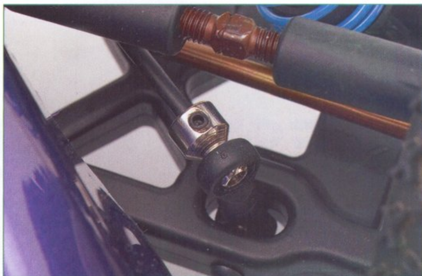
Detalle de la barra estabilizadora delantera, montada sobre rótulas esféricas de acero de gran suavidad.
