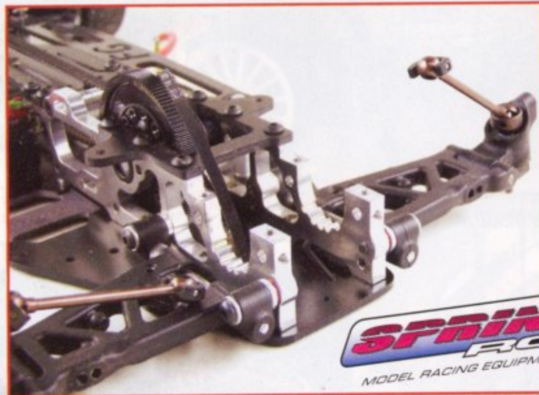
Le spalle posteriori con l'alloggiamento del differenziale che funge anche da tendicinghia.
