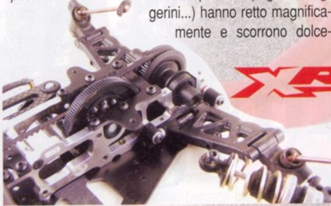
La trasmissione primaria e il differenziale posteriore.
