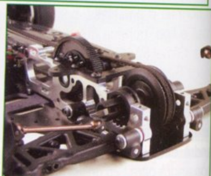
Il differenziale alloggiato nelle spalle.
