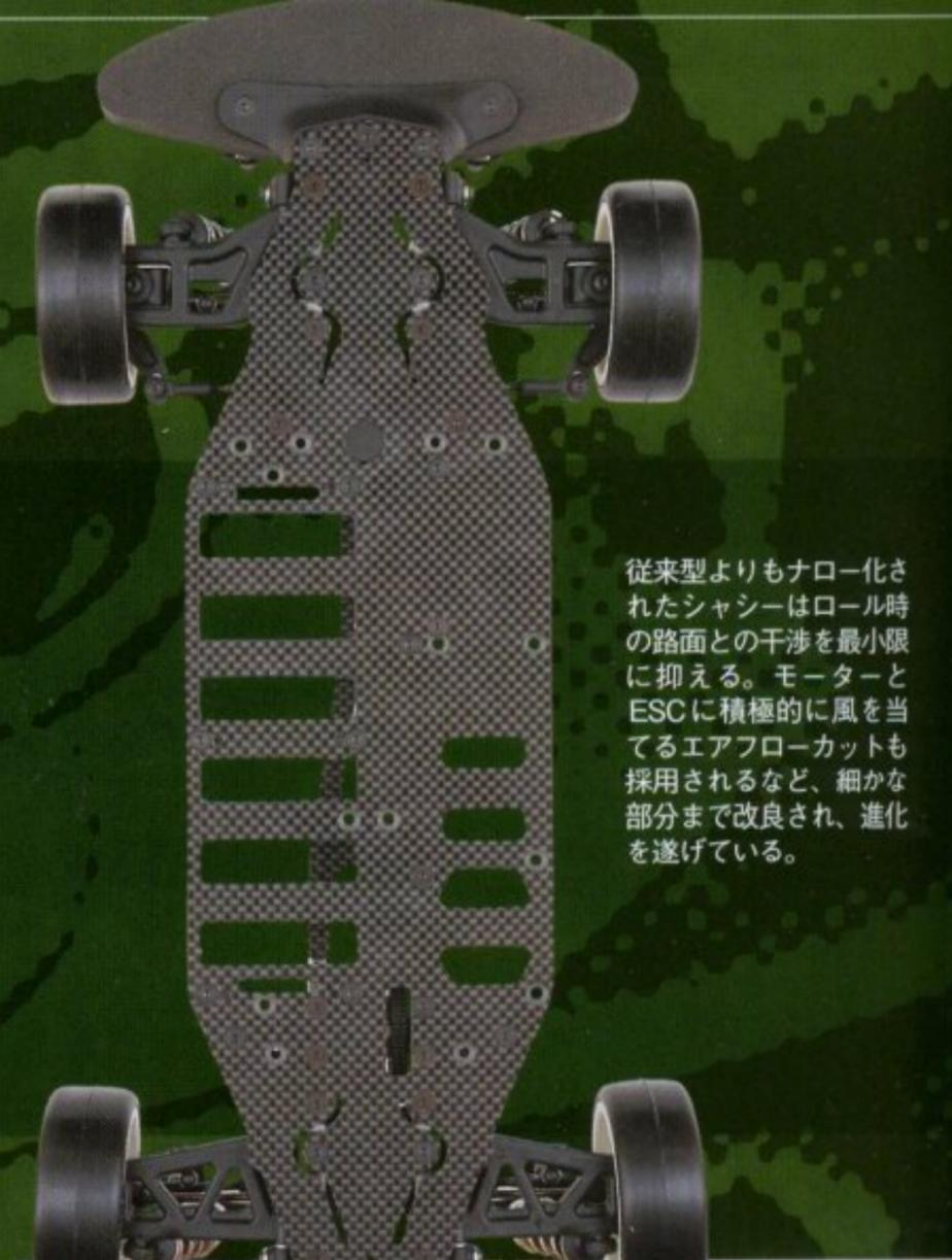
従来型よりもナロー化されたシャシーはロール時の路面との干渉を最小限に抑える。モーターとESCに積極的に風を当てるエアフローカットも採用されるなど、細かな部分まで改良され、進化を遂げている。
