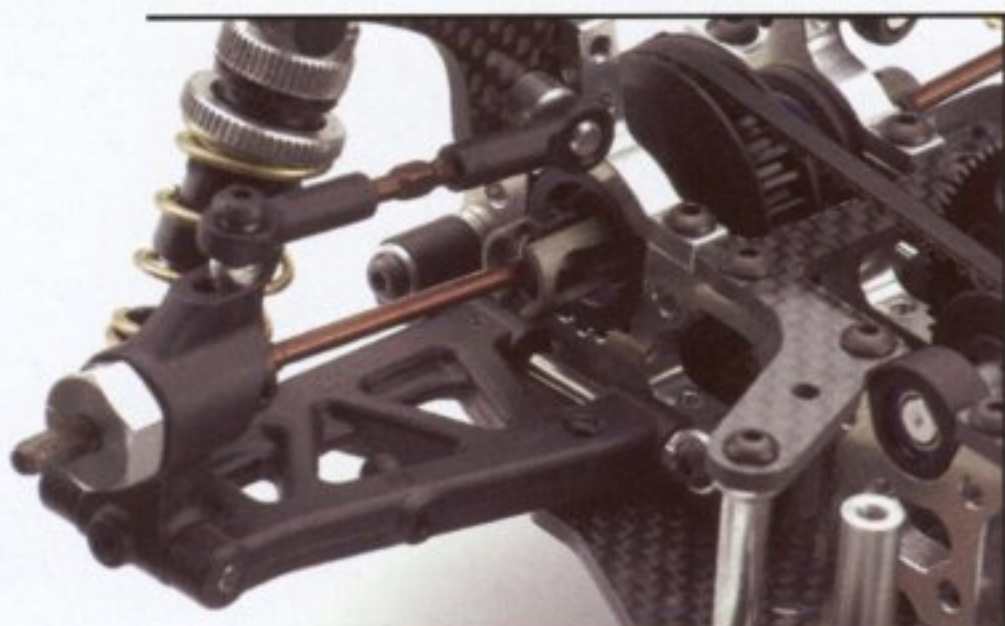
Die Schwingen (hier an der Hinterachse) gibt es in verschiedenen Kunststoffhärten.
