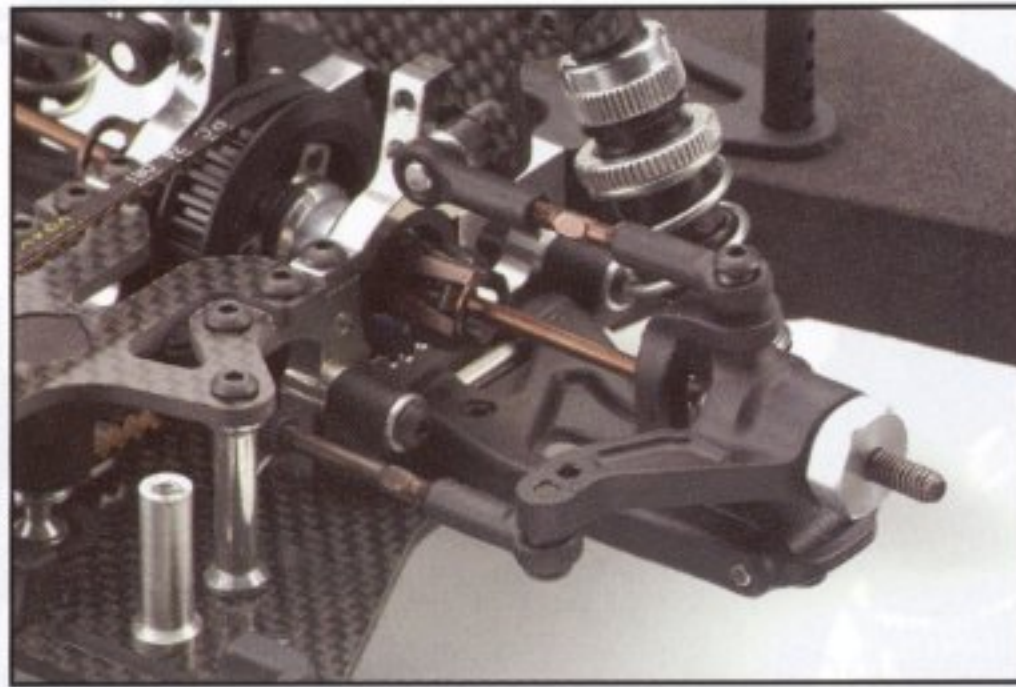
Kardans und alle Rechts/Links-Gewinde sind aus Hudy-Federstahl.
