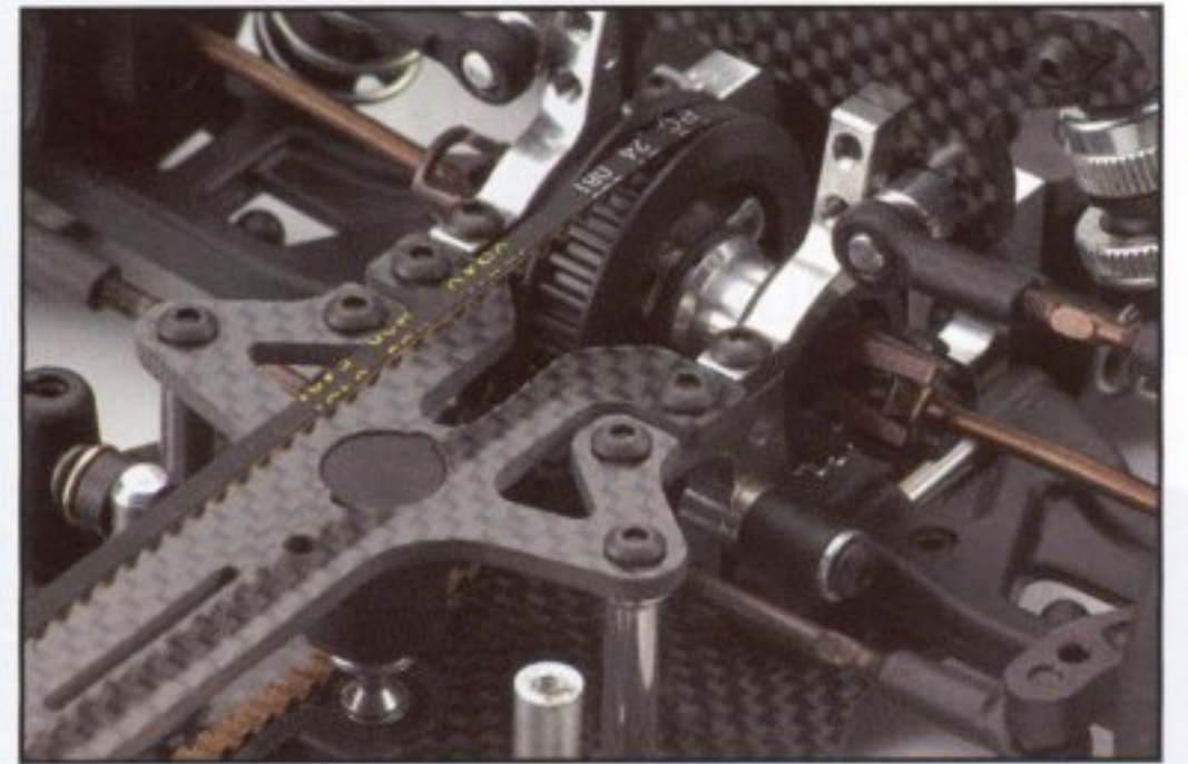
Flex-Technology für variable Chassis-Steifigkeit.
