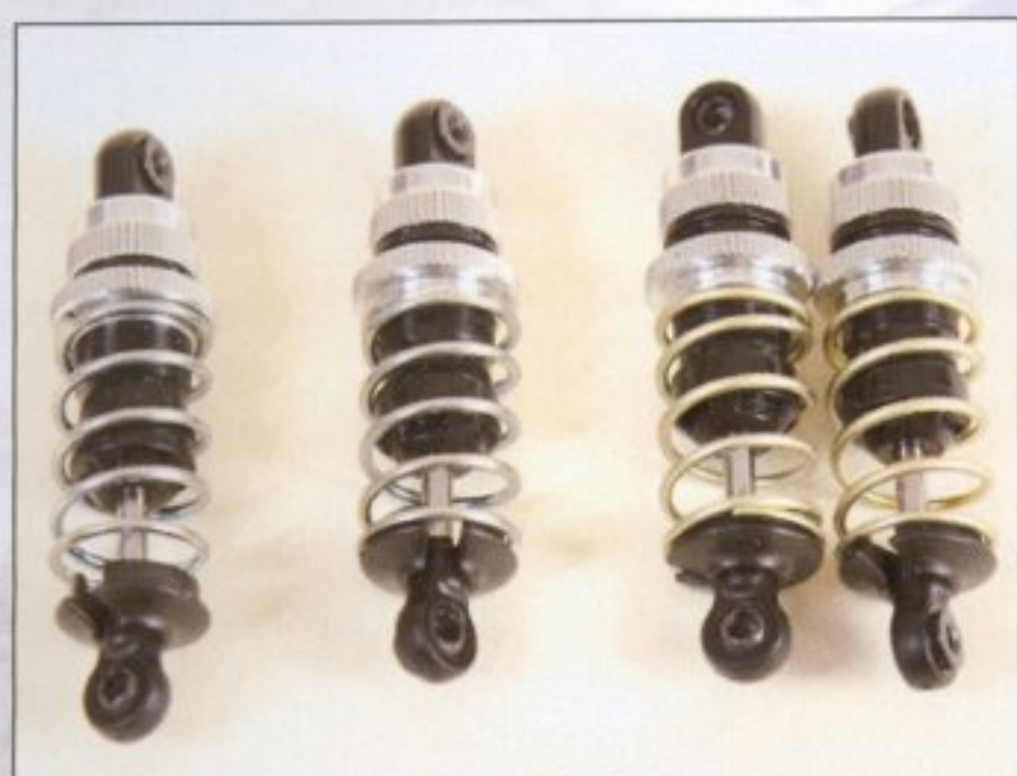
Die Stoßdämpfer können sowohl mit variabler als auch mit fester Lochplatte montiert werden.
