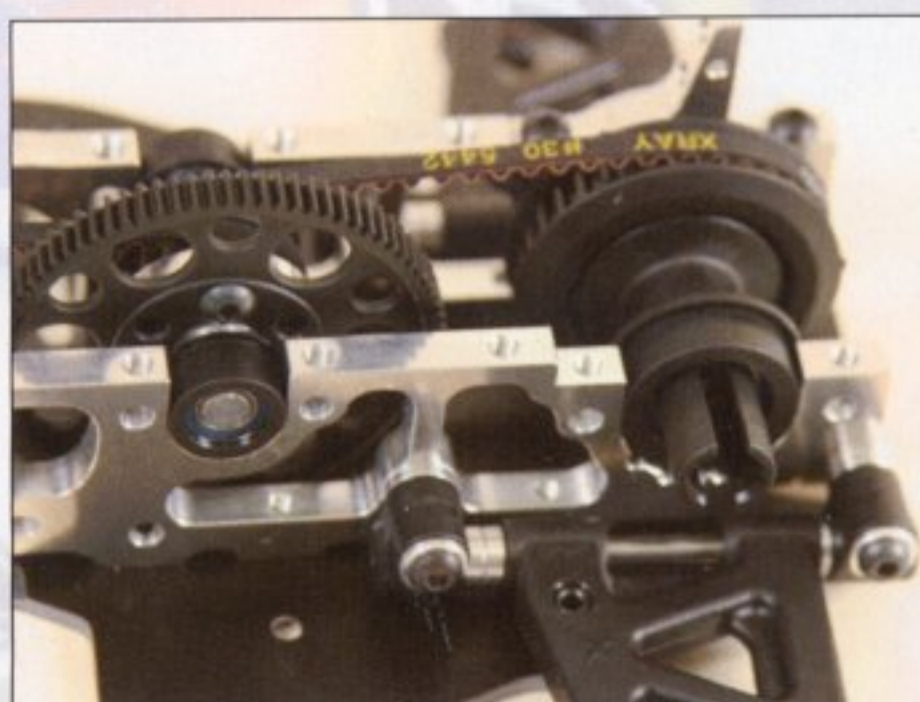
Die eingebaute Mittelwelle und das hintere Differenzial. Die Abdeckung fehlt noch.
