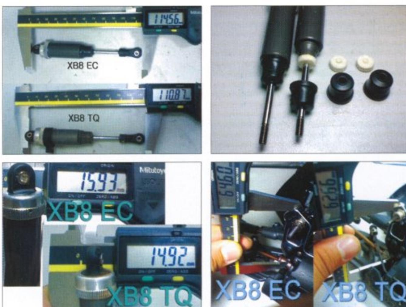
센터 디프 위치가 변하여 TQ보다 뒤로 4mm 정도 이동하였고, 엔진도 중심 쪽으로 1mm 정도 이동하여 전체적으로 무게 중심이 약간 뒤로 이동하였다. 덕분에 차량의 주행성과 점프 후 차량의 자세 등이 더욱 안정적으로 변하였다.
