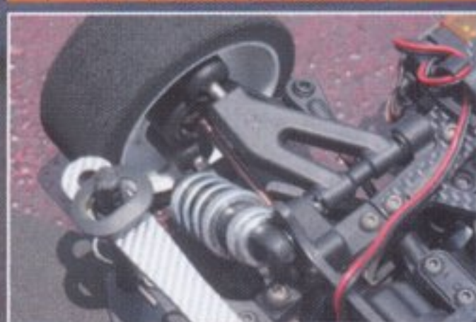
▲前上擺臂、前下擺臂、後下擺臂、後輪座都是可以左右共用的膠件。
