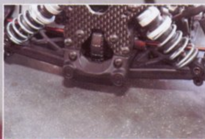
▲前後擺臂的軸心可藉由偏心襯套位置更換，改變車輛的滾動中心。
