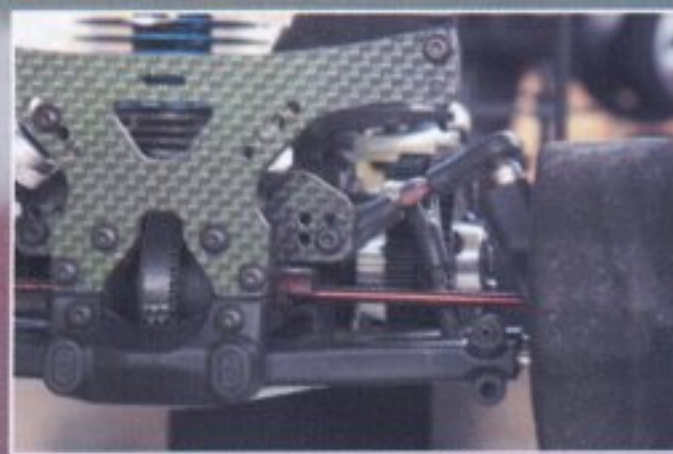
▲後上I字臂擁有4個孔位，可作擺臂不同變化量的調整。
