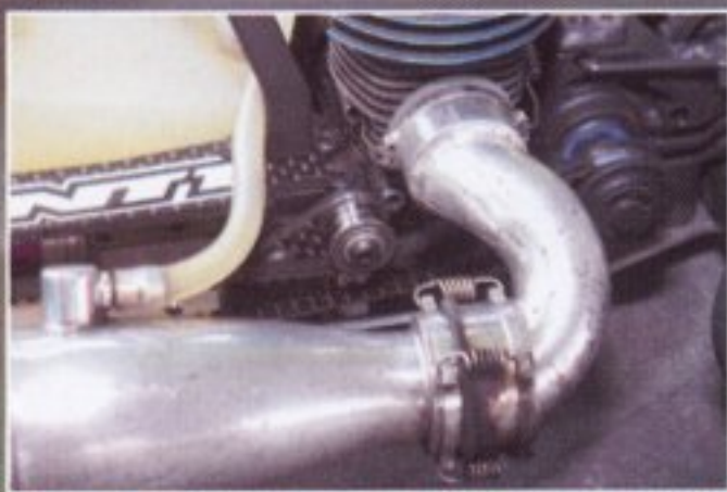
▲皮帶壓輪則是裝置在專屬的碳纖維板上，以方便調整皮帶間隙。
