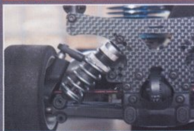
▲XRAY的避震器能在不換油的情況之下，作四階段不同阻尼的設定。
