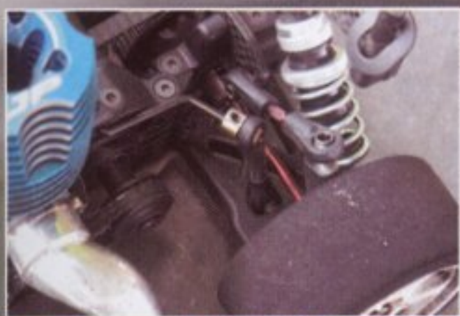
▲後防傾桿則是使用線徑型的防傾桿，藉由球頭位置推移改變效果。
