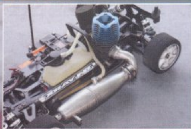
▲試駕時所使用的JP引擎及SIRIO EFRA 2611加速管。
