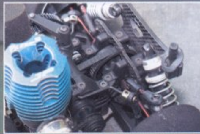
▲XRAY NT1擁有最小的差速裝置，減輕了驅動上的負擔。
