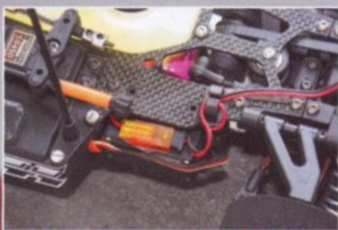
▲平躺式的伺服機安裝，已成為各大車輛低重心的設計指標。
