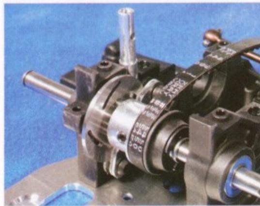
*Il disco del freno è inserito in modo flottante su due spine bloccate, per interferenza, nel trascinatore della puleggia di rimando al differenziale posteriore. Il disco è in acciaio, rettificato da entrambe le parti ed alleggerito da feritoie ad arco, che ne aumentano la capacità radiante per il raffreddamento.*
