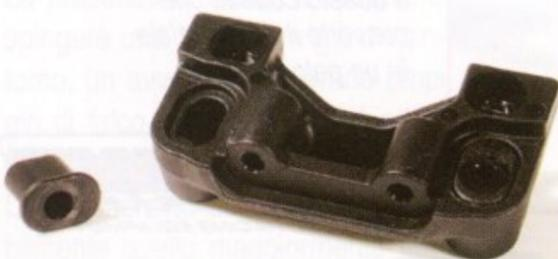
*Il tappo posteriore della NT1 fuoriesce in modo evidente dal perimetro del telaio. Anche qui, gli inserti di regolazione del punto di rollio si inseriscono ed estraggono con estrema*
