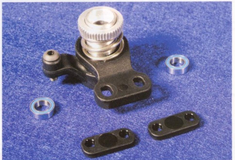
*Comodissimi i due inserti, che permettono ben quattro possibili angoli di Ackermann. Per il resto, il salvaservo della NT1 è molto semplice e del tutto simile per struttura a vari altri già visti.*
