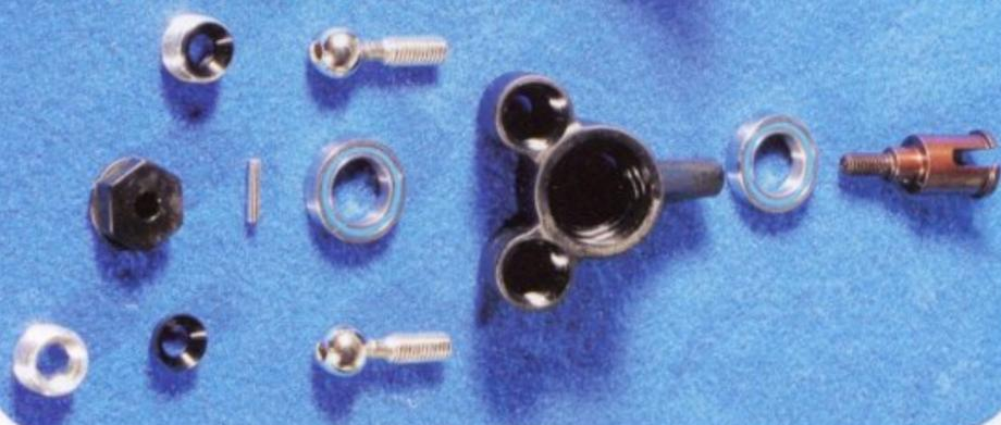
*... colla cianoacrilica ad alta densità. Per il resto profusione di qualità sia di materiali che realizzativa. Eterni e precisissimi i mozzi in Spring Steel, la lega d'acciaio brevettata da Hudy. Solo il trascingitore esagonale in plastica stona in un equilibrio di elevato prestigio come questo.*
