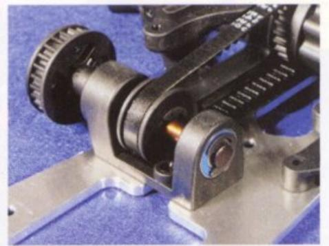
*Il banchino di rinvio delle pulegge ha una configurazione del tutto usuale ed integra l'alloggiamento della vite di ritenzione anteriore del supporto batterie.*
