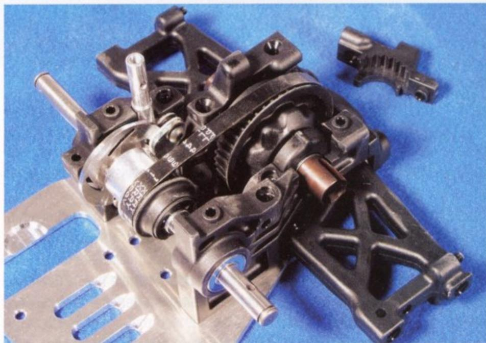
*La cellula anteriore con i cavallotti che permettono di regolare la tensione della cinghia. La posizione indicata come "standard" nelle istruzioni è perfetta. Anche qui, come al retrotreno, un aspetto dei braccetti decisamente "massiccio", soprattutto se confrontato all'apparente "gracilità" delle spalle.*
