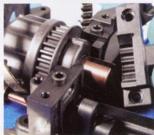
*La presenza di questi due "prigionieri", oltre a fissare con precisione la posizione del cavallotto, collabora ad aumentare la rigidità del sistema. Per estrarre il differenziale anteriore, è sufficiente rimuovere solo quattro viti!*
