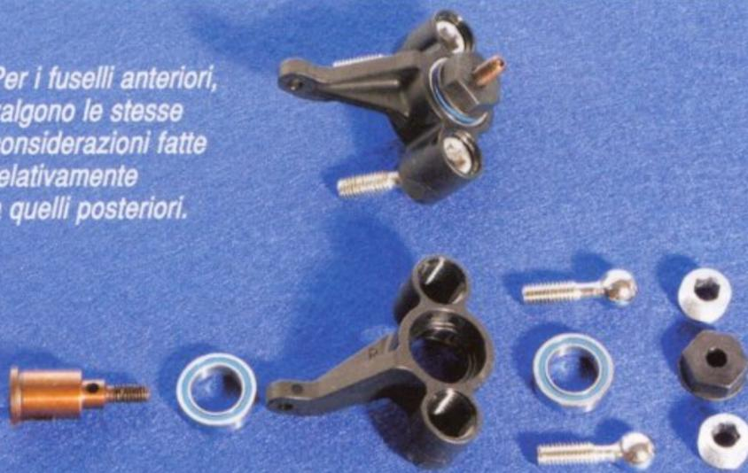
*Il fusello posteriore della X-Ray NT1 montato e in pezzi. Nessun accorgimento salvo quello di incollare gli anellini in plastica sui grani in ergal con del Pattex o...*
