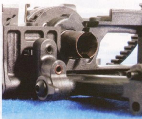
*...il foro esagonale, attraverso il quale, con una chiave a brugola da 1,5 mm, potrete regolare semplicemente e rapidamente l'inclinazione della barra. In questa foto, si nota in modo evidente il notevole abbassamento del differenziale.*
