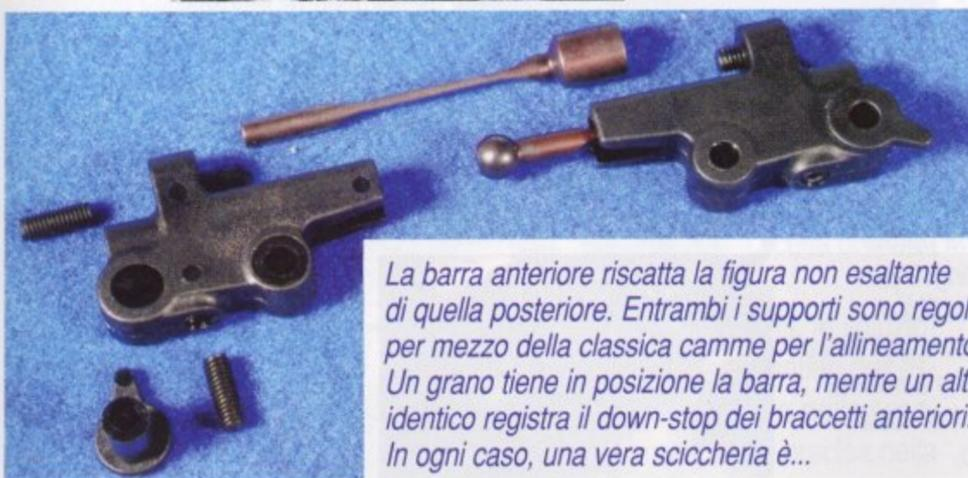
*La barra anteriore riscatta la figura non esaltante di quella posteriore. Entrambi i supporti sono regolabili per mezzo della classica camme per l'allineamento. Un grano tiene in posizione la barra, mentre un altro identico registra il down-stop dei braccetti anteriori. In ogni caso, una vera sciccheria è...*
