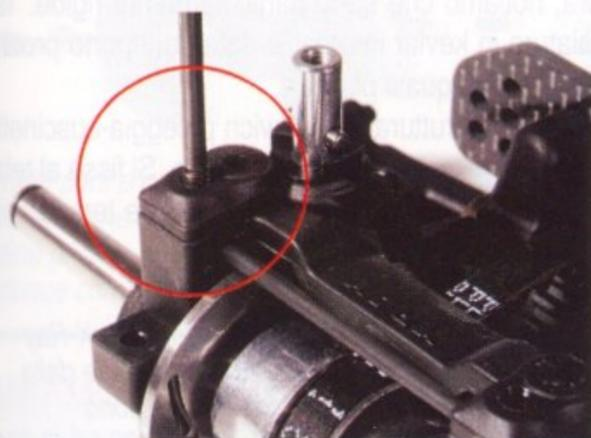
*Un grano registra e tiene in posizione la barra nell'apposita gola, una soluzione piuttosto artigianale che mal si inserisce nel contesto di una così puntigliosa ingegnerizzazione delle soluzioni adottate.*
