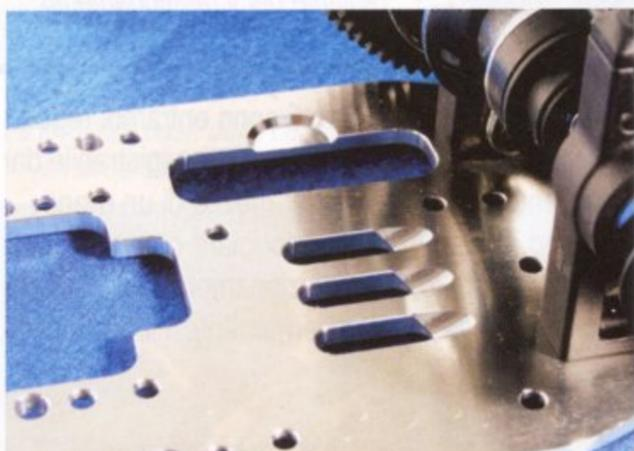
*In corrispondenza del carter motore, sono state scavate tre feritoie, così che esso possa usufruire di un flusso addizionale di raffreddamento. Una profonda fresatura sul telaio fa spazio alla campana della frizione.*
