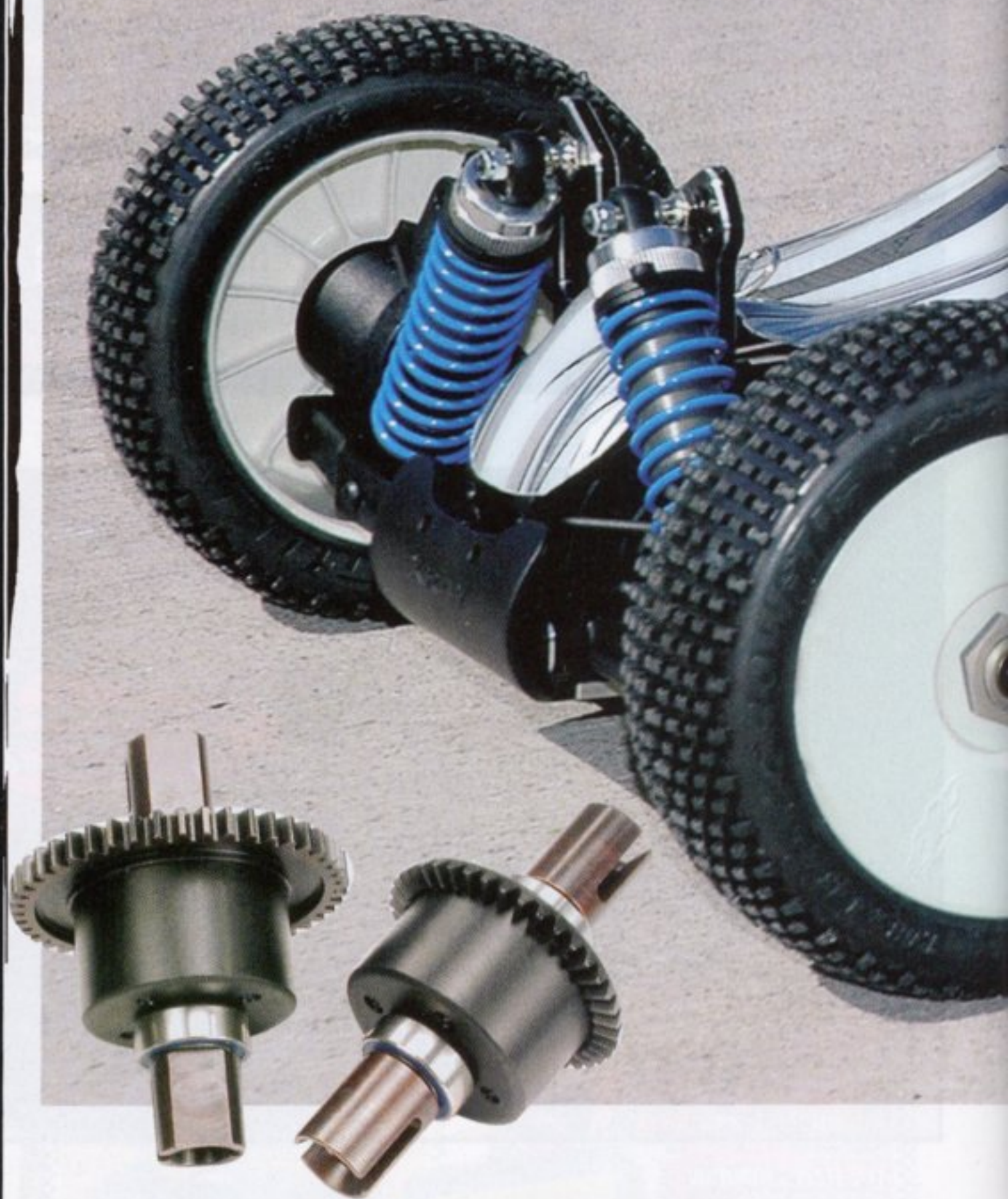
Le XB8 EC dispose de trois différentiels à pignons coniques en acier.
