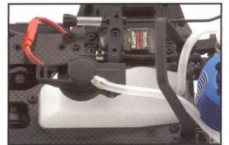
Tief liegender Tank mit Sinterfilter und Diffusor.
