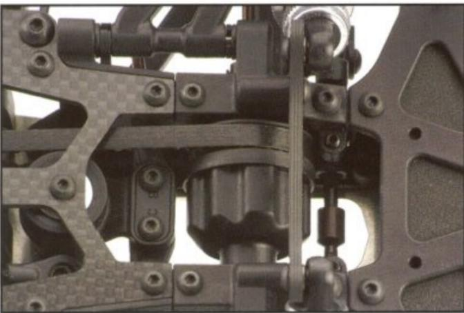
Sehr kompaktes und kleines Kegelrad-Differential, verstellbarer Ackermann-Effekt und Kugelstabilisator vorne.
