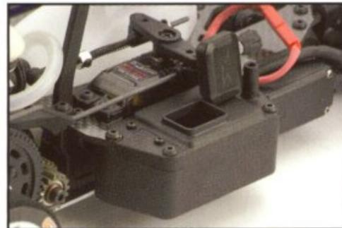
Geschlossene Empfängerbox mit Öffnung zum Quartzwechsel.
