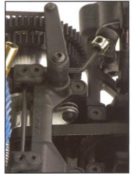
Stahlscheibenbremse und Bügelstabilisator hinten.
