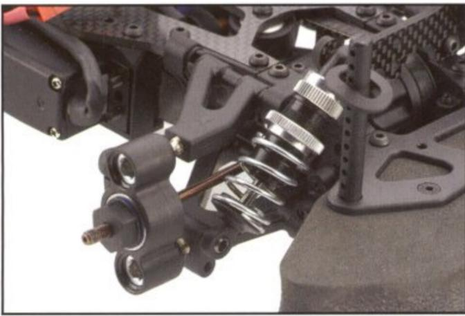
Einzelradaufhängung vorne und hinten (Bilder Vorderachse), alle Antriebsteile aus Hudy Federstahl, Stoßdämpfer mit verstellbarer Härte und Federvorspannung.
