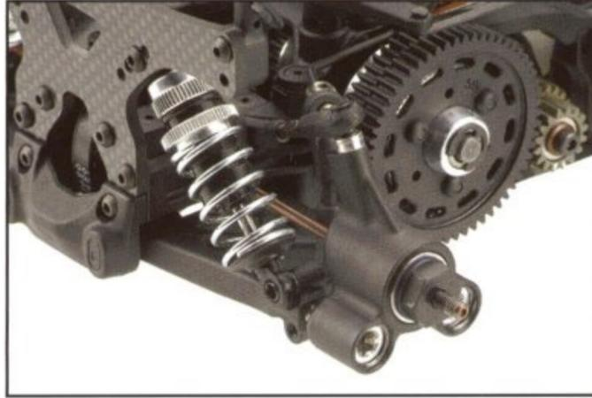
Der hintere Achsbock ist über Pivots und eine Gewindestange komplett einstellbar.
