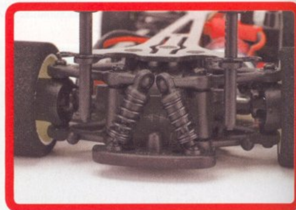
Der Winkel der Federelemente kann an deren unterer Lagerung eingestellt werden
