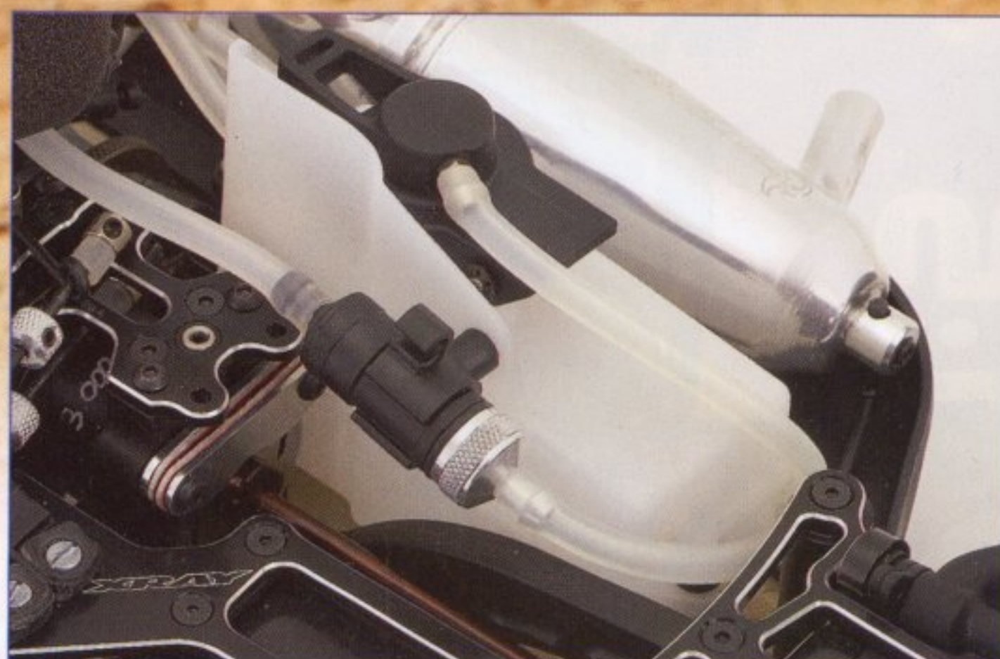
El XB8EC cuenta con un nuevo filtro y depósito de combustible, con la estanqueidad mejorada.
