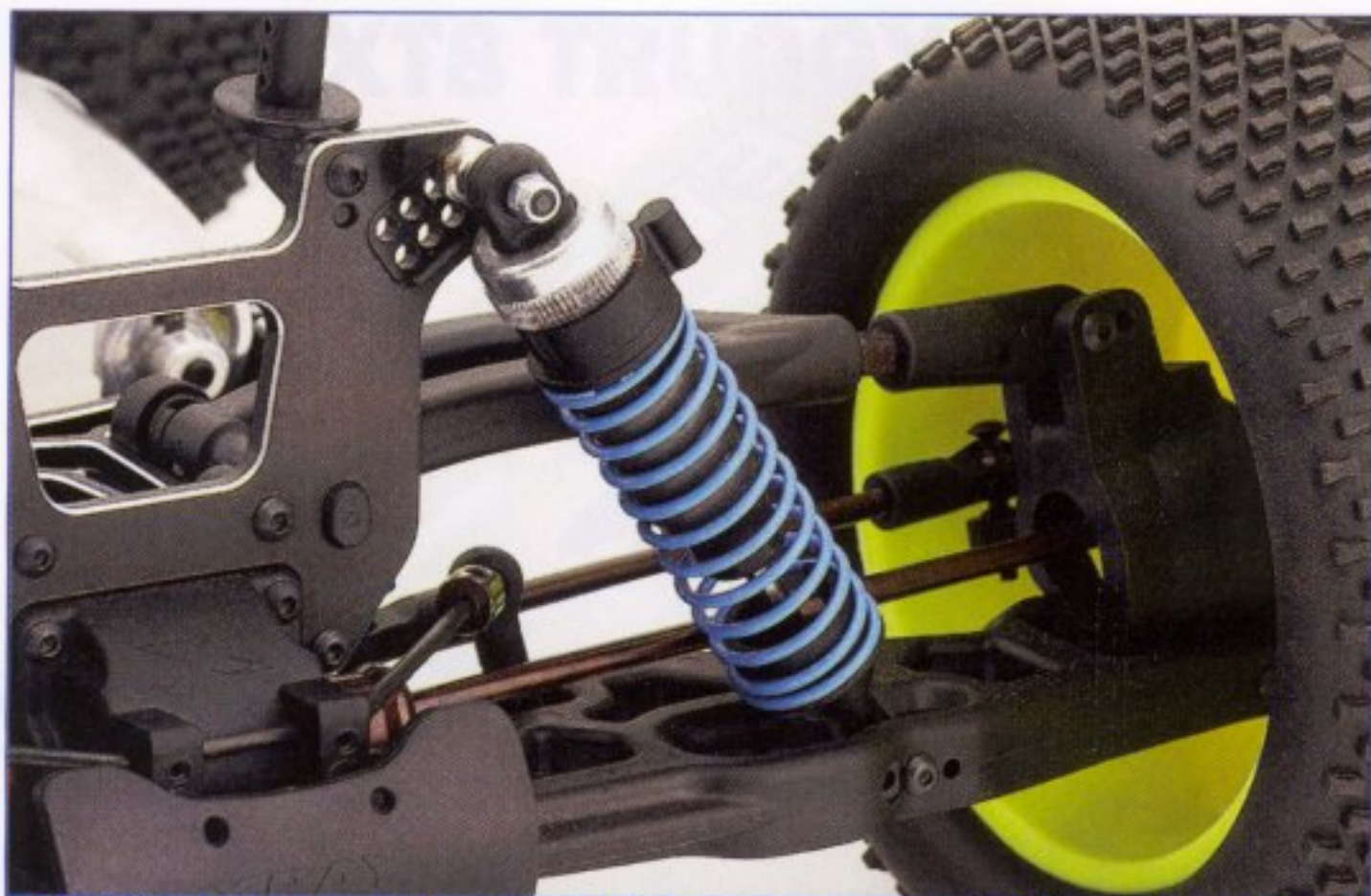
Detalle de los amortiguadores delanteros, muy sobredimensionados, y torreta delantera reforzada.
