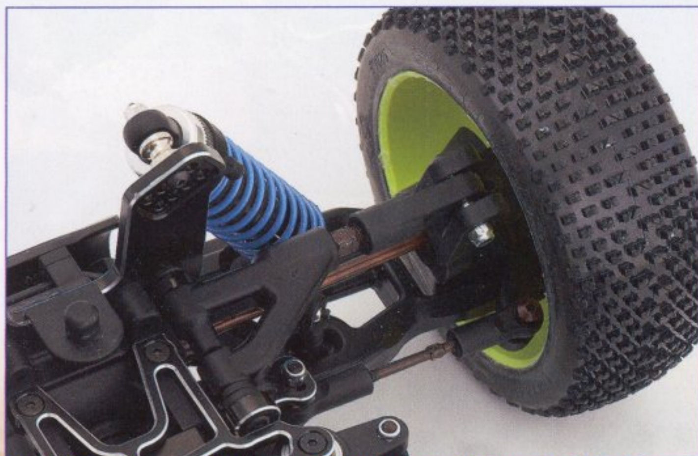
Detalle de los nuevos trapecios delanteros que incorpora el XB8EC.
