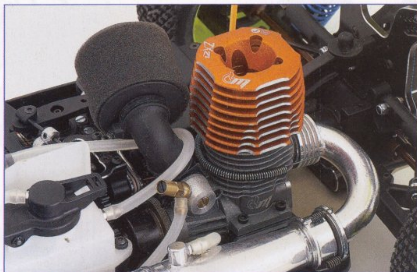
En esta nueva versión el motor se encuentra más retrasado para mejorar el reparto de pesos.
