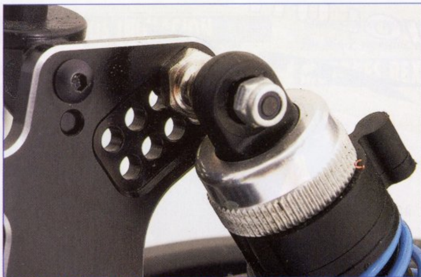
Los puntos de anclaje de los amortiguadores a las torretas son excelentes y proporcionan una elevada rigidez.
