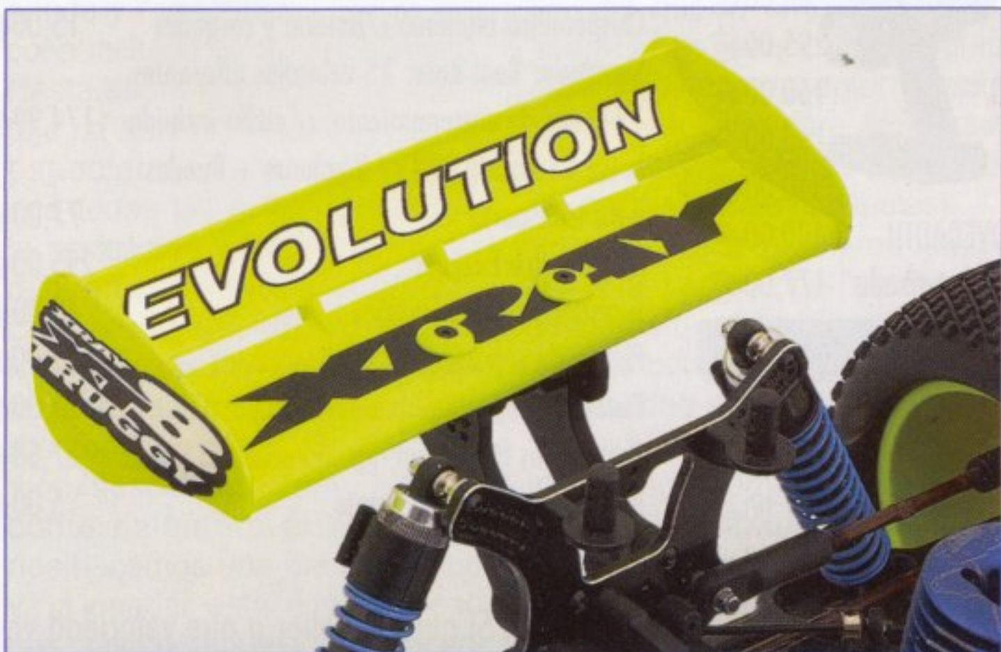
El alerón es aerodinámico y dispone de un soporte flexible con multitud de posibles reglajes.
