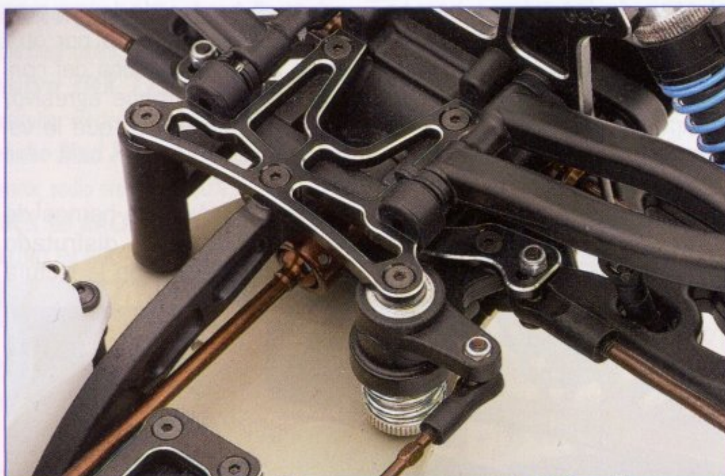
Primer plano de la unión del grupo delantero con el chasis y el salvaservos. Cuenta con rigidificadoras muy robustas.
