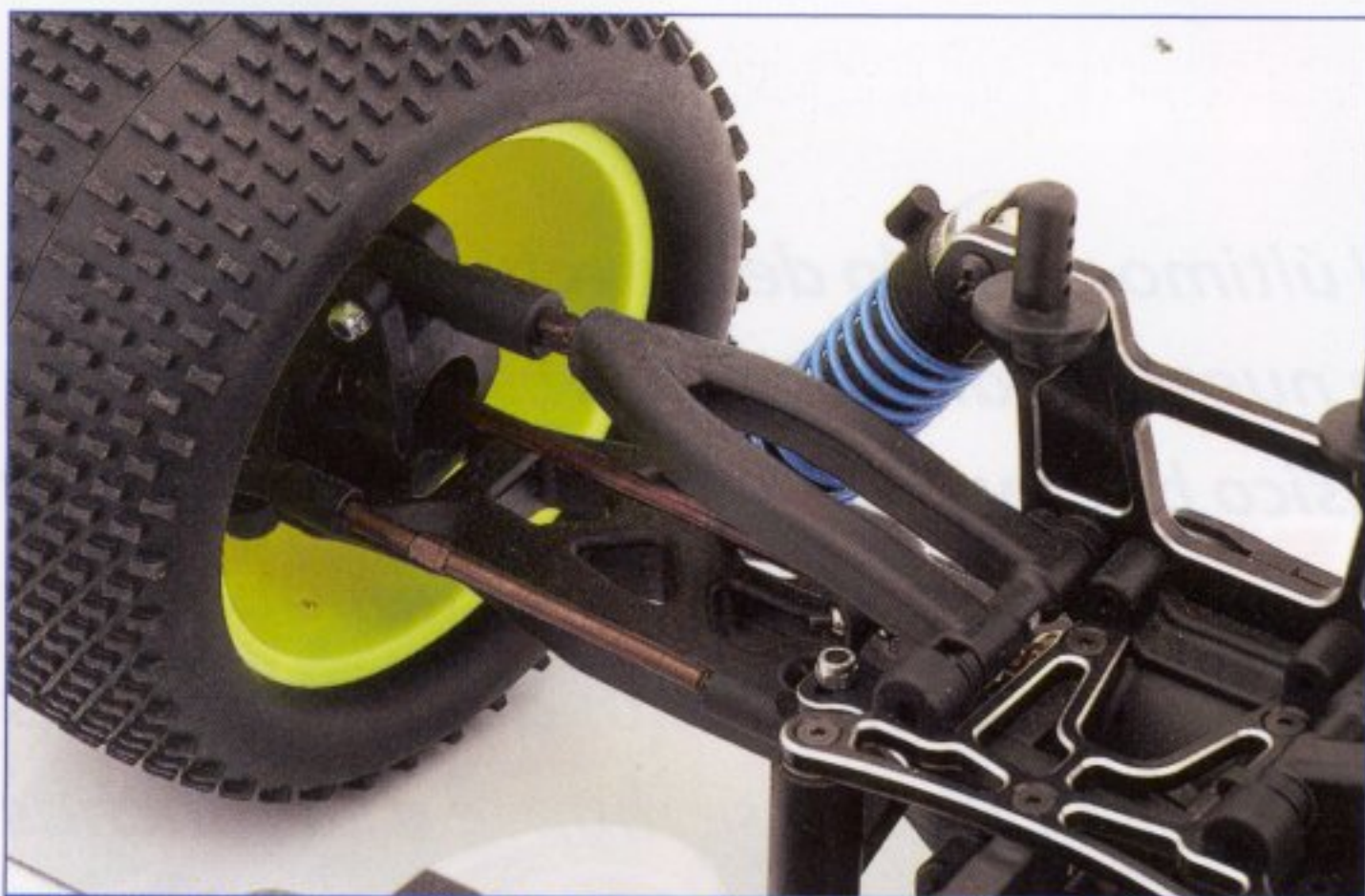
Trapezio delantero curvado para mejorar la amplitud del recorrido de suspensión.
