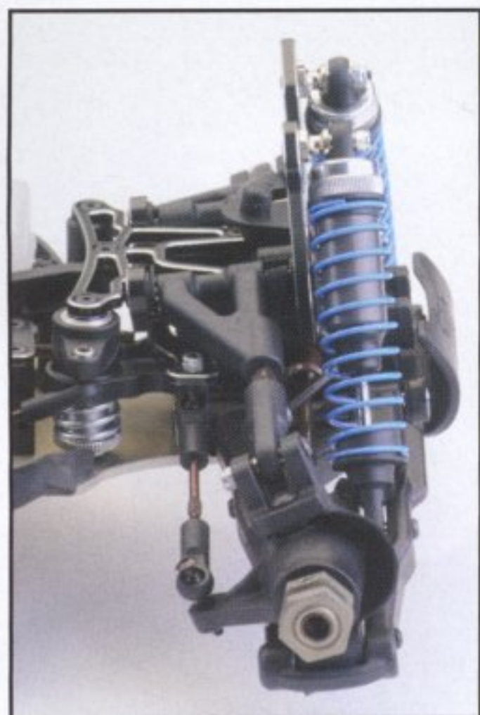
An der Vorderachse einstellbarer Anti-Dive und Nachlauf.
