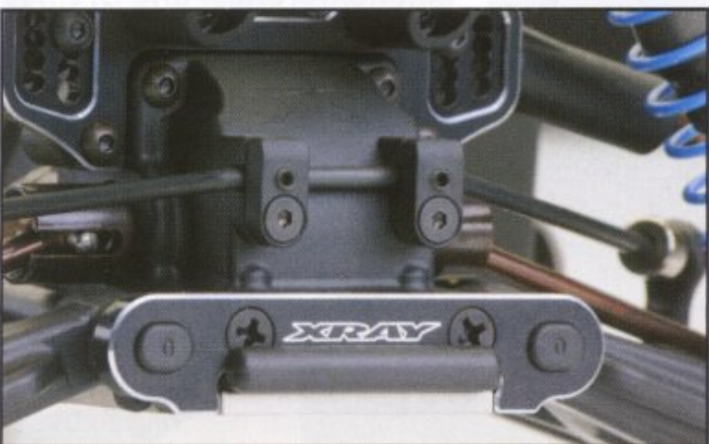
Querlenkerhalter aus T6 mit Einsätzen zur Spureinstellung
