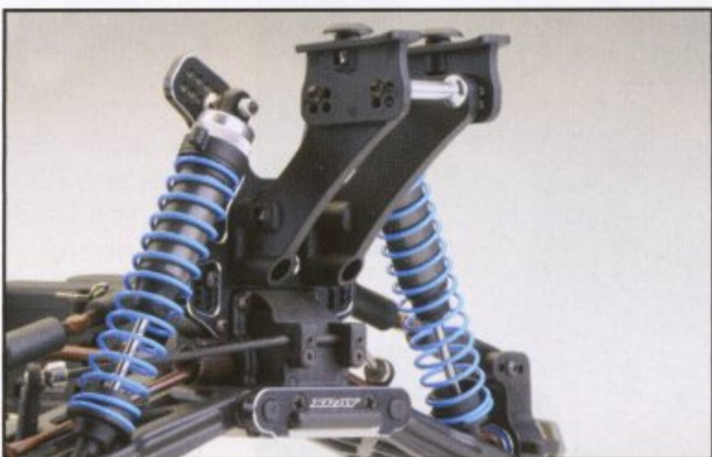
Hohe Dämpferbrücken aus T6 7075 Alu und Dämpfer mit langen Federwegen.
