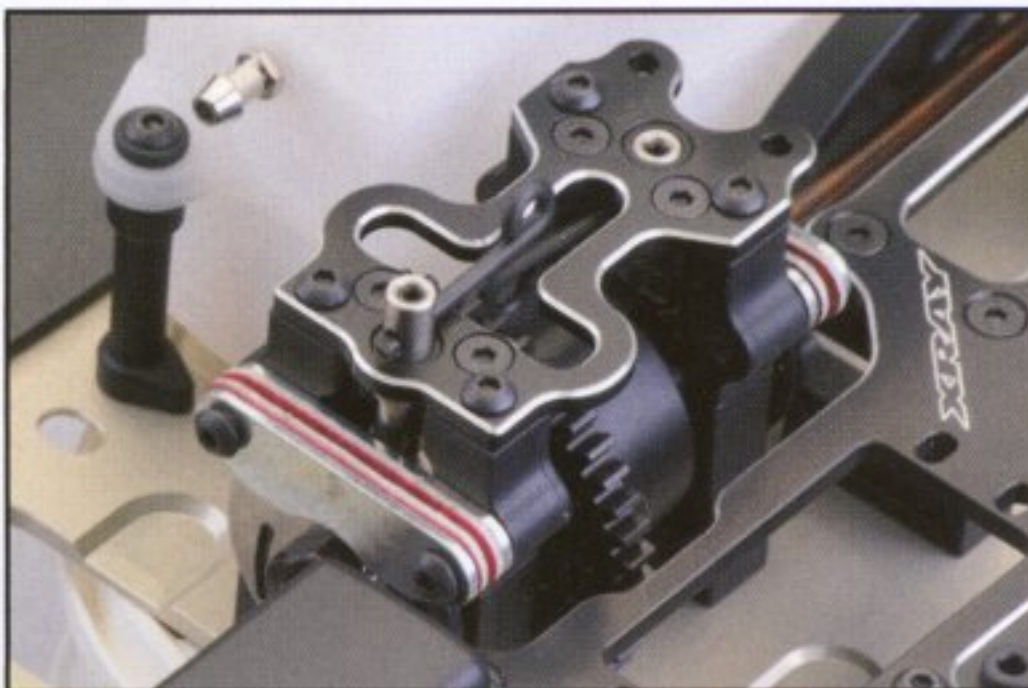
Mitteldifferential-Getriebe mit Scheibenbremsen für vorne und hinten.
