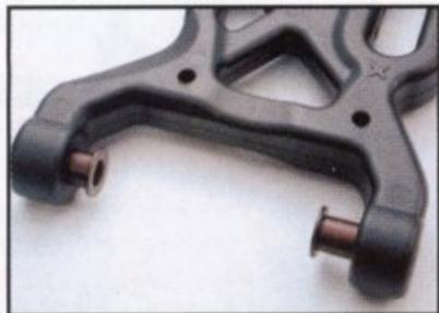
Les axes qui maintiennent les porte-fusées avant passent au travers de petits canons en acier logés dans les triangles.
