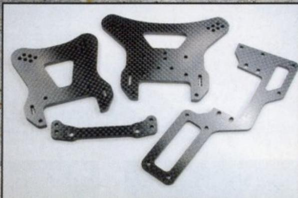
Supports d'amortisseurs, platine radio et traverse de direction sont d'origine en carbone !
