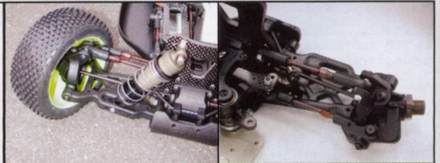
La suspension avant du 808 est équipée de simples tirants supérieurs. Notez la largeur des étriers de porte-fusées pour rigidifier l'ensemble de la suspension, d'où la forme particulière des triangles.
