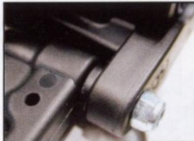
Il sera possible d'avancer ou de reculer les triangles inférieurs avant et arrière grâce à deux petites rondelles de ce type.
