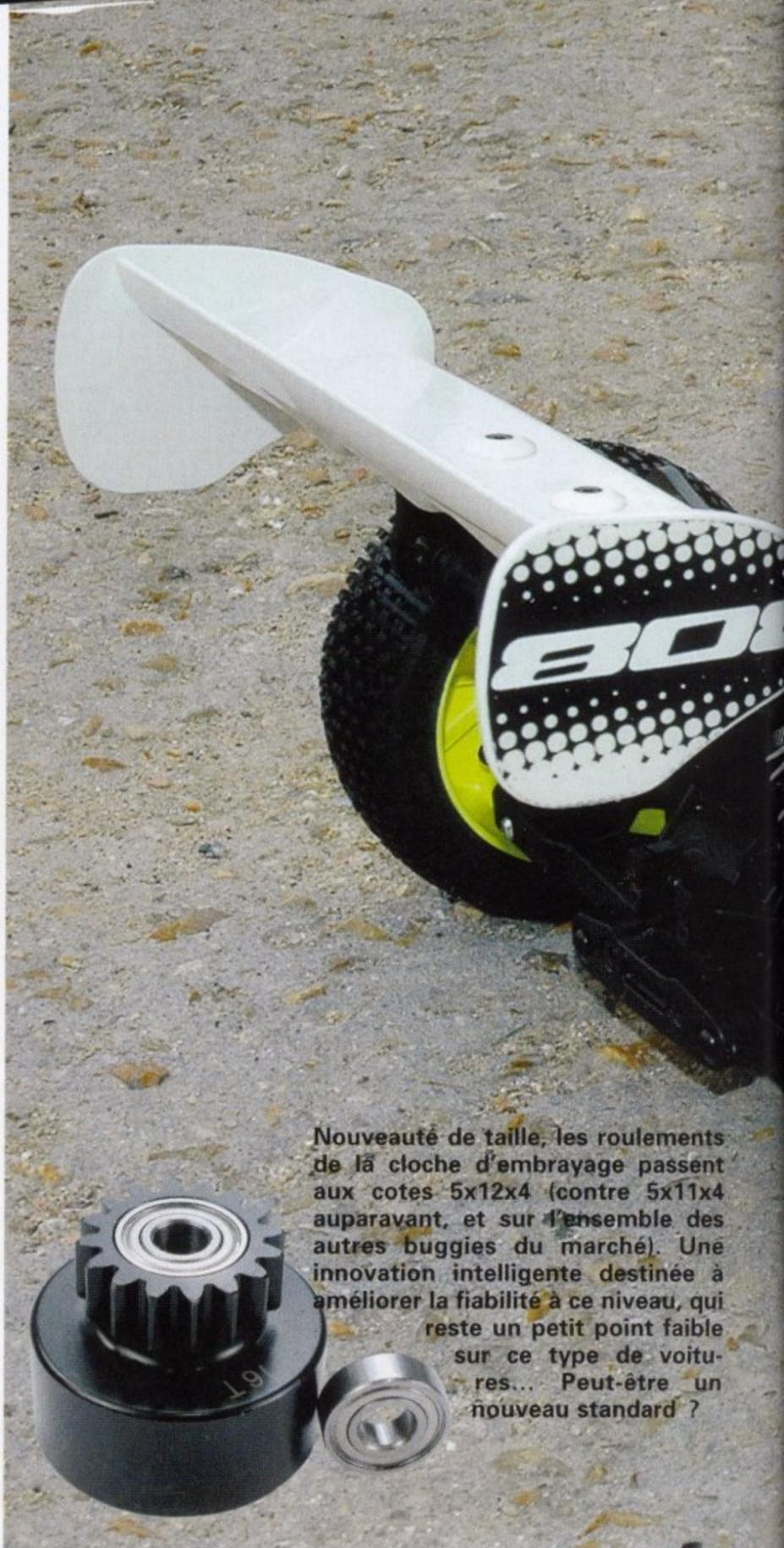
Nouveauté de taille, les roulements de la cloche d'embrayage passent aux cotes 5x12x4 (contre 5x11x4 auparavant, et sur l'ensemble des autres buggies du marché). Une innovation intelligente destinée à améliorer la fiabilité à ce niveau, qui reste un petit point faible sur ce type de voitures... Peut-être un nouveau standard ?
