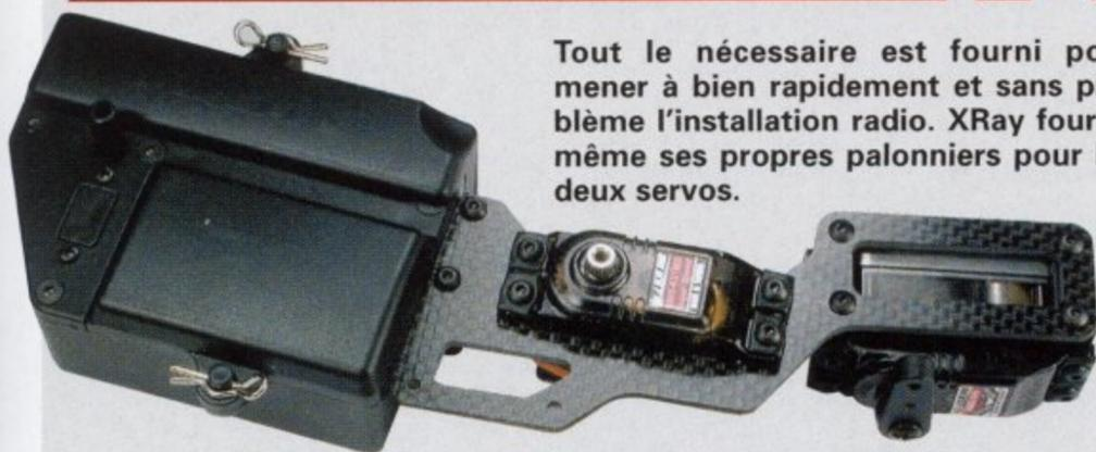
Tout le nécessaire est fourni pour mener à bien rapidement et sans problème l'installation radio. XRay fournit même ses propres palonniers pour les deux servos.
