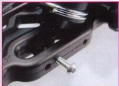
Originalité du 808 ! On trouve deux vis de fixation basses d'amortisseurs de couleur argent et deux vis noires dans le kit. Attention, les argent sont des vis spéciales à pas inversé, à placer à l'avant gauche et à l'arrière gauche. La raison est la suivante : XRay a constaté que parfois les vis de ces deux endroits précis ont tendance à se desserrer.
