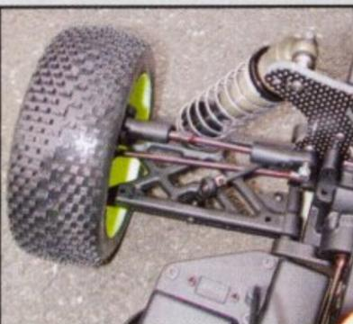
La suspension arrière est pour sa part, plus classique. On y trouve, comme sur tous les autres TT 1/8 du marché, des triangles inférieurs et des tirants supérieurs. Notez que d'origine, la suspension dispose d'axes de triangles filetés d'un côté, qui reçoivent donc un écrou nylstop.
