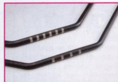
La section des barres anti-roulis avant et arrière se repère en un clin d'œil grâce à de petites marques sur leur partie centrale : d'origine 2,4 mm et 2,6 mm respectivement à l'avant et à l'arrière.
