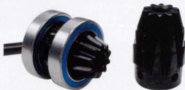
Les extrémités des cardans centraux sont en fait les pignons d'attaque des couples coniques. Moins de pièces, moins de poids, disparition des deux vis, très astucieux !
