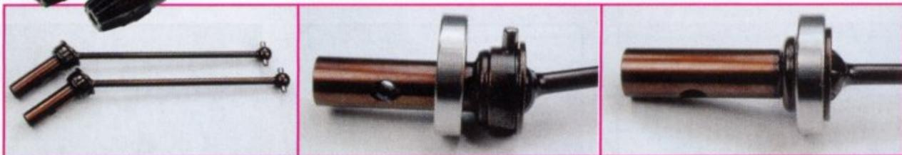
Les cardans de roues sont en acier Hudy, comme le reste des pièces de la transmission. Notez que, là aussi, la vis de blocage de la goupille a disparu, puisque c'est le roulement intérieur qui se charge de la retenir.
