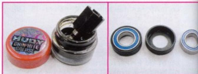
N'oubliez pas de déposer un peu de graisse graphite au niveau des sorties de différentiel. Notez que les roulements de diff sont plus petits que les anciens. Cependant, ils sont placés dans une bague en plastique pour, au final, retrouver un diamètre extérieur identique à celui des anciens roulements. Cela veut dire que vous pourrez réutiliser vos anciens différentiels si vous avez un XB8 (à condition de remplacer les couronnes).
