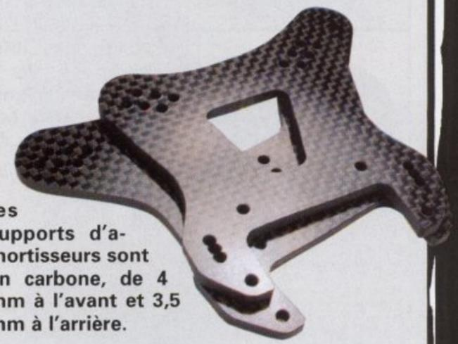
Les supports d'amortisseurs sont en carbone, de 4 mm à l'avant et 3,5 mm à l'arrière.
