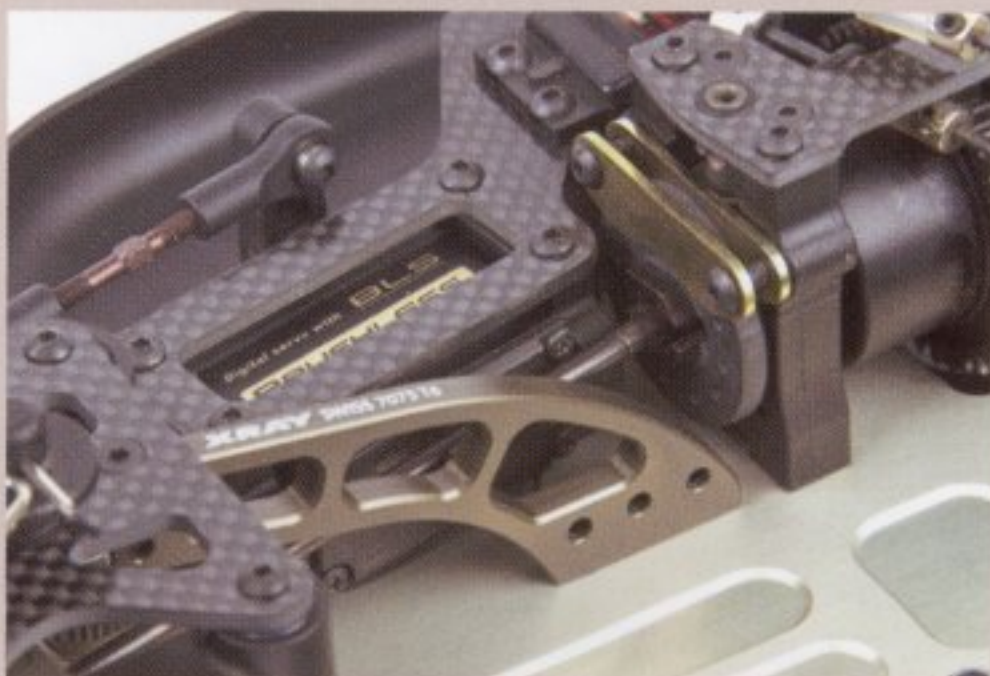
Met de aluminium steunen ingebouwd wordt de wagen heel stijf, perfect voor kunstgras.
