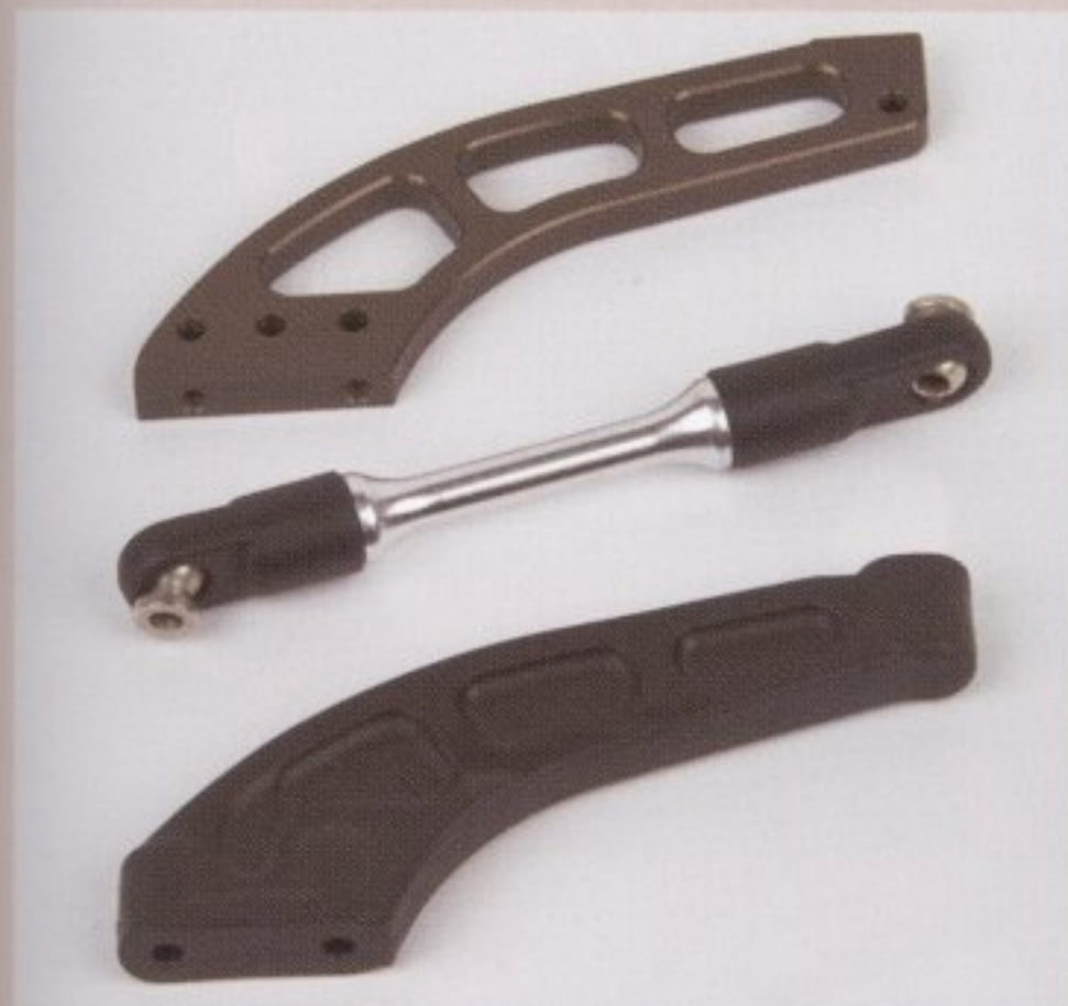
De drie soorten chassisverstevingen die aan de voorzijde gemonteerd kunnen worden.
