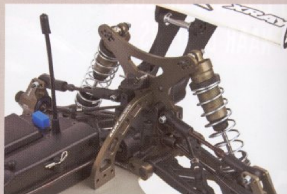
Met de aluminium steunen ingebouwd wordt de wagen heel stijf, perfect voor kunstgras.
