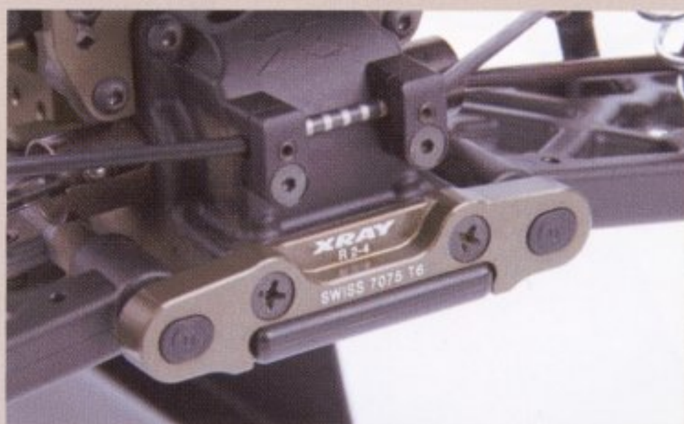
De aluminium toe-in blokken aan de achterkant geven je heel wat afstel mogelijkheden.
