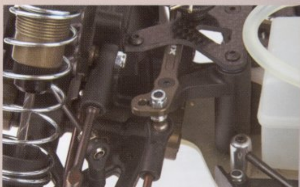
De aluminium stuurplaat is wel zo veilig op een baan met veel obstakels.
