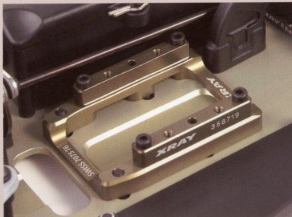
In de wagen zorgt de optionele mount daadwerkelijk voor extra steun aan de motor.
