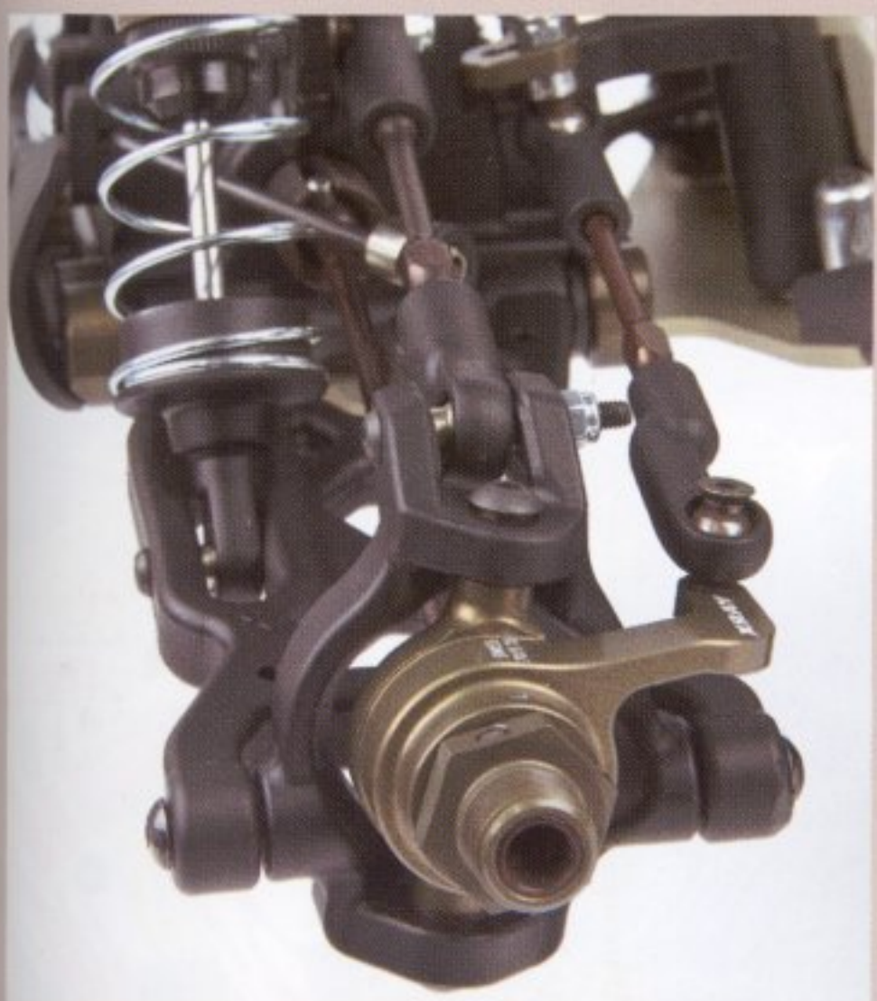
De aluminium stuurblokken zijn crashbestendig en zien er goed uit.
