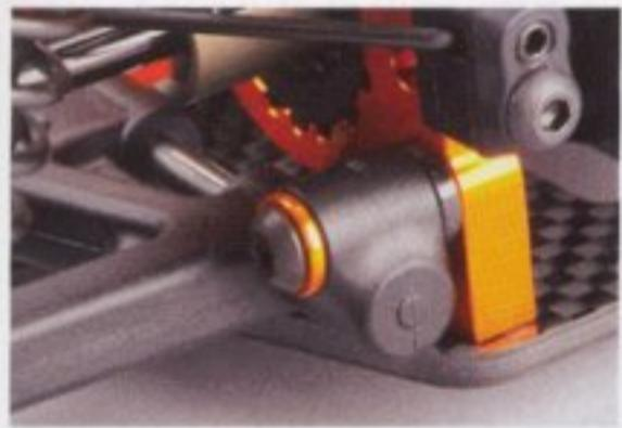
サスマウントはバルクヘッドとの間にスペーサーを挿入することにより、リアのト一角を自在に変更できる。
