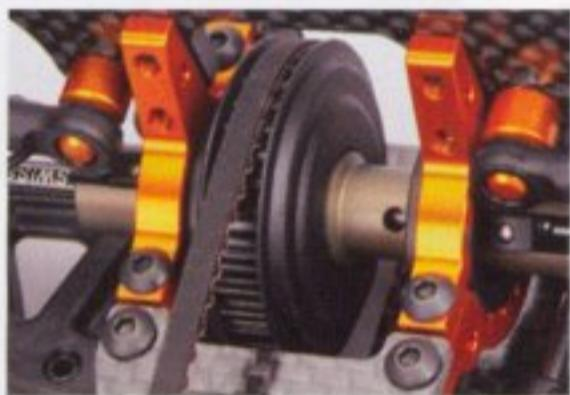
ゴミの侵入をシャットアウトするフルカバードのリアデフ。搭載したままのデフ調整も可能だ。
