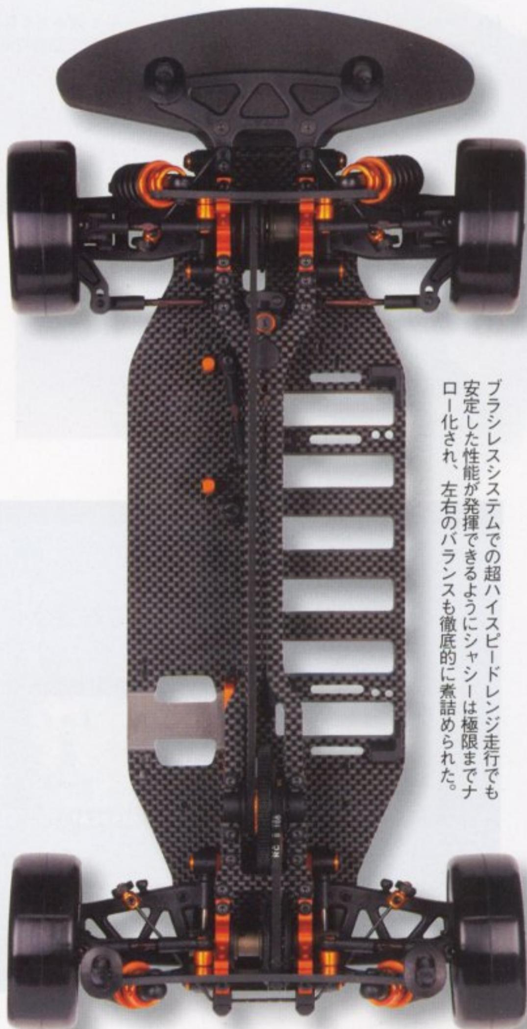
ブランレスシステムでの超ハイスピード走行でも安定した性能が発揮できるようにシャシーは極限までナロ化され、左右のバランスも徹底的に煮詰められた。
