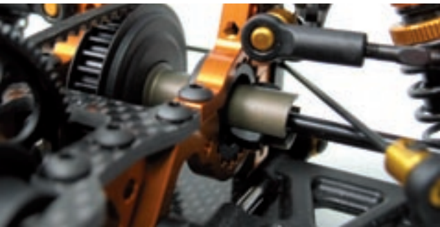
Alu-Sechskant-Mitnehmer mit Klemmung zur Radaufnahme runden das Bild ab
