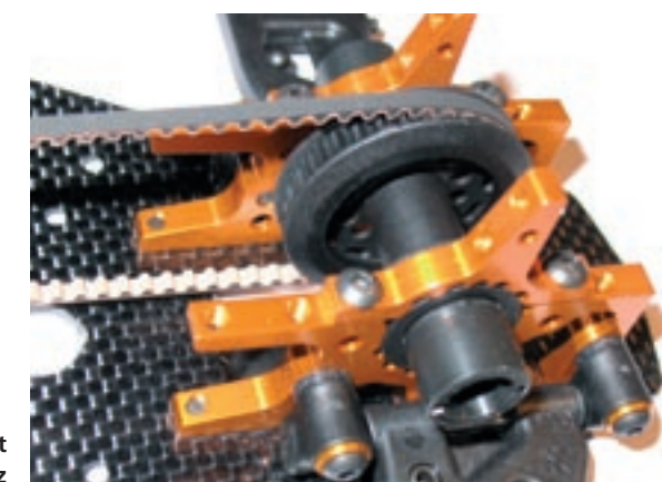
An der Vorderachse kommt ein Durchtrieb zum Einsatz
