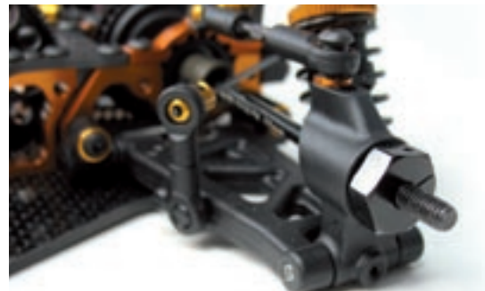
Alu-Sechskant-Mitnehmer mit Klemmung zur Radaufnahme runden das Bild ab
