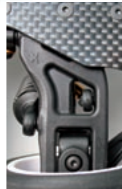
Die Kugeln zur Stabilisierung sind Bestandteil der Schwingen
