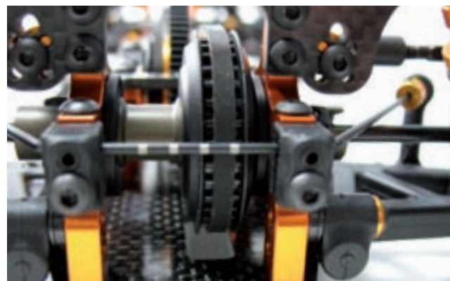
Die Leichtlaufriemen des T2 009 sind extrem schmal
