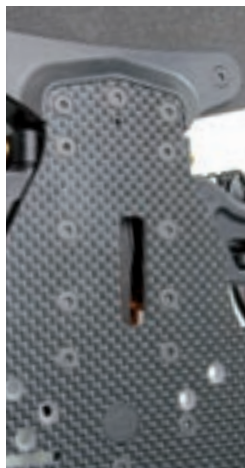
Vollkommen glatt: An der Chassis-Unterseite wurden alle Bohrungen gesenkt
