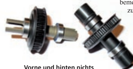
Vorne und hinten nichts Neues: Kugeldiff und Spool
