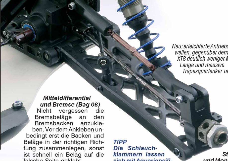
Neu: erleichterte Antriebswellen, gegenüber dem alten XT8 deutlich weniger Masse. Lange und massive Trapezquerlenker unten.
