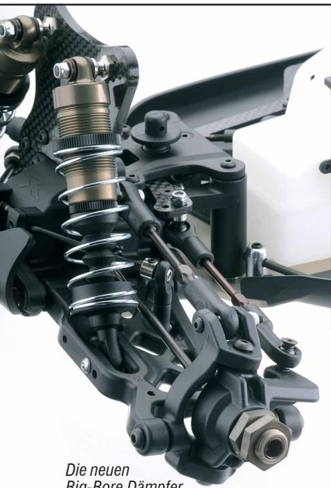
Die neuen Big-Bore Dämpfer des XB 808 2009 bieten jetzt Shock-Boots statt der Abstreifer in den unteren Verschlusskappen. Die Differentialgehäuse wurden im XB808 2009 verstärkt.
