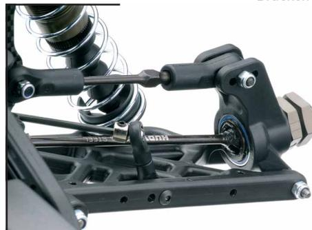
Die großen Kugellager in den Radträgern machen Madenschrauben in den Kardan-Gelenken überflüssig, die Pins können nicht mehr herausfallen. Der Ausfederweg kann an allen unteren Querlenkern eingestellt werden. Die Drehachsen sind im XB808 mit Stoppmuttern verschraubt.
