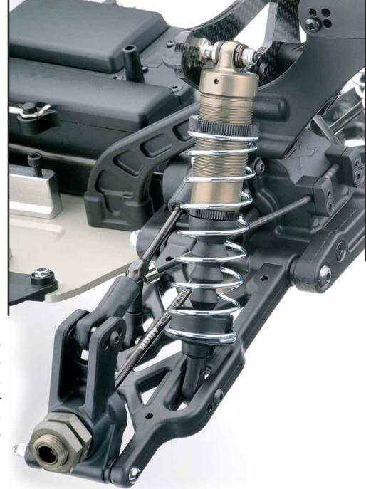
Rändelschrauben an den Stoßdämpfern ermöglichen eine stufenlose Einstellung der Bodenfreiheit. Die Big-Bore Dämpfer hängen an massiven Brücken aus Carbon.
