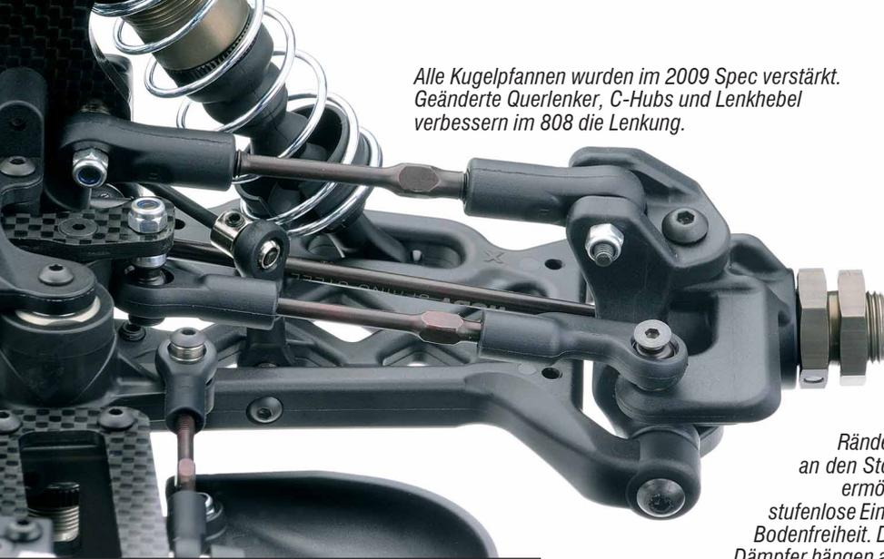
Alle Kugelpfannen wurden im 2009 Spec verstärkt. Geänderte Querlenker, C-Hubs und Lenkhebel verbessern im 808 die Lenkung.
