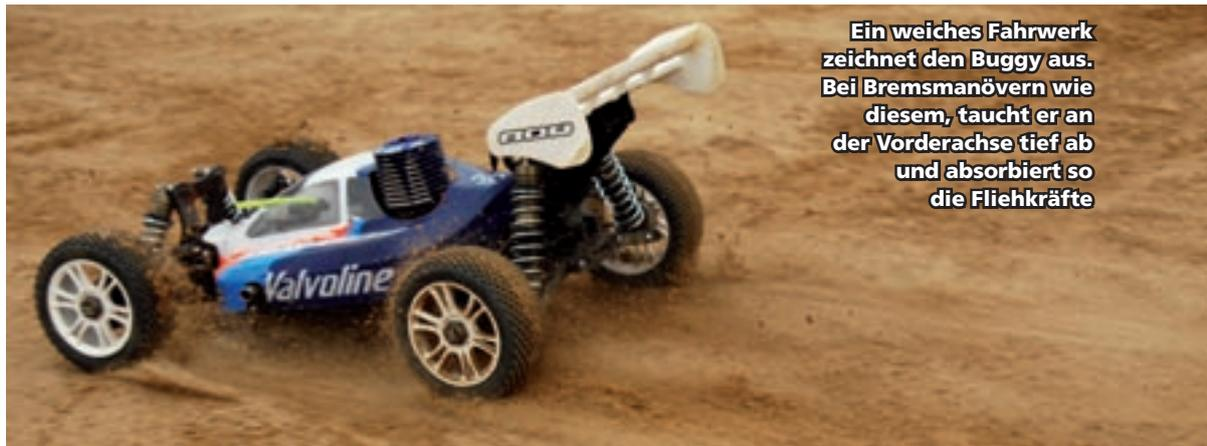
Ein weiches Fahrwerk zeichnet den Buggy aus. Bei Bremsmanövern wie diesem, taucht er an der Vorderachse tief ab und absorbiert so die Fliehkräfte
