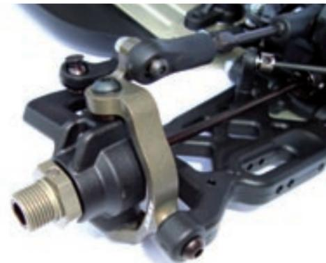
Mit den Alu-C-Hubs bildet die Vorderachse eine sehr robuste Einheit
