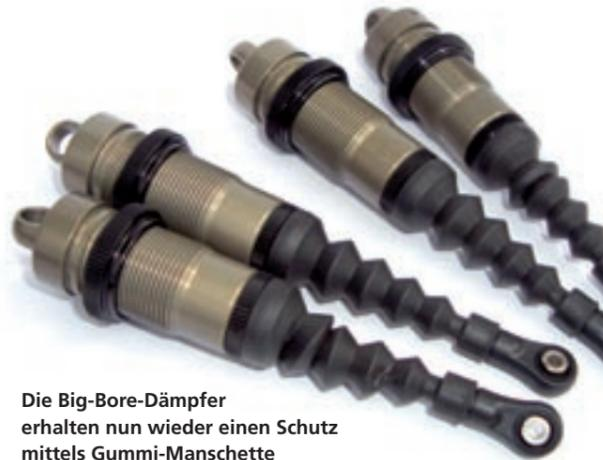
Die Big-Bore-Dämpfer erhalten nun wieder einen Schutz mittels Gummi-Manschette
