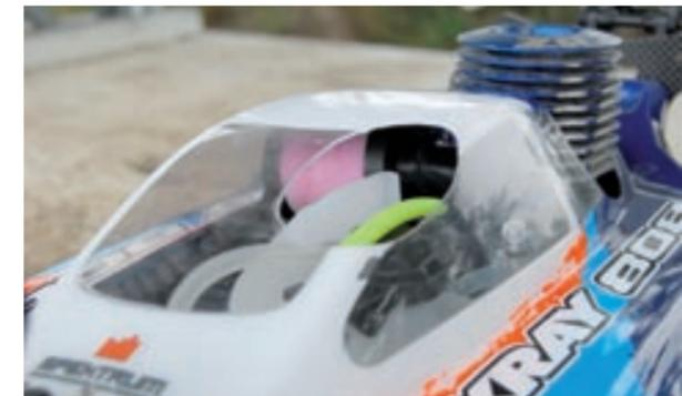
Eng geht es zu unter der neuen Haube. Der Luftfilter passt gerade so, dafür hat nun aber der Motor mehr Luft am Kühlkopf
