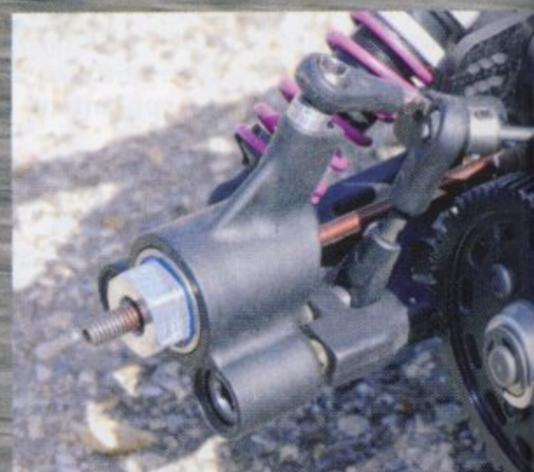
La mécanique de la NT 1 dispose d'une barre anti-roulis arrière très efficace dont les points d'attache s'effectuent dans l'alignement des triangles inférieurs.
