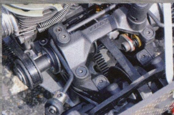
La barre anti-roulis arrière est une version traditionnelle conçue en corde à piano. Elle fixe la section à 2,2 millimètres.
