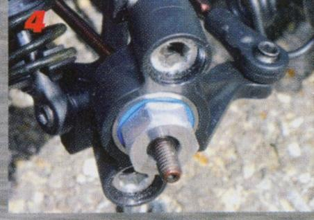
1- Sur la grande majorité des circuits, Mathias préfère utiliser l'axe rigide sur l'essieu avant. L'auto apparaît ainsi un peu plus paresseuse en entrée de courbe, mais se révèle en contrepartie bien plus facile à gérer en sortie au moment de remettre plein gaz. À noter que sur la NT 1, la pièce en aluminium que nous apercevons ici est la même qui permet aussi de passer sous le mode de la roue libre.
