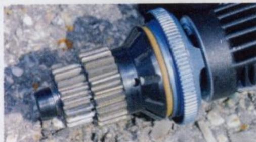
Mathias n'utilise pas l'embrayage XRay d'origine. Il fait appel à un modèle de marque Capricorn qui entretient la différence par un poids réduit de 10 grammes en rapport de celui de série. Il en résulte des montées en régime plus franches. L'autonomie se situe de son côté entre 5.15 et 5.30 minutes selon les circuits.
