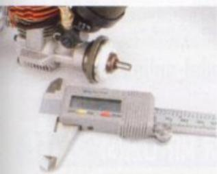
Afin de régler correctement l'embrayage, il est indispensable de disposer d'un pied à coulisse.
