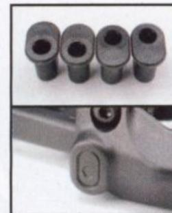
L'anti-cabrage arrière et l'anti-plongée avant sont ajustables via de petits inserts excentriques dans lesquels les axes de triangles viennent se loger.
