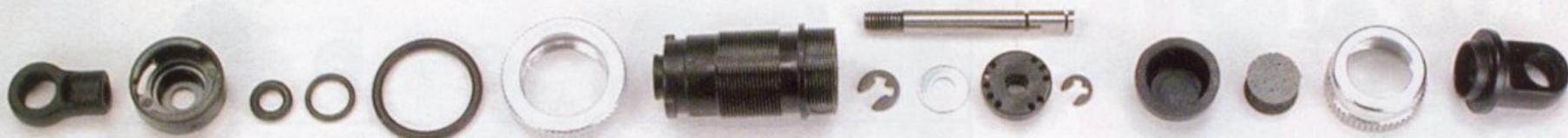
Les amortisseurs sont hydrauliques et disposent d'un corps en plastique. Ils restent entièrement à assembler.
