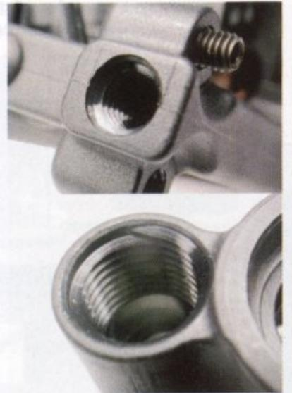
Dans un souci de perfection et afin de faciliter le montage, les plastiques recevant les grosses rotules de suspension - tels que triangles - sont filetés, ainsi que les logements de bouchons pour les portes-fusées avant et arrière. Cela évite également tout assemblage de travers.
