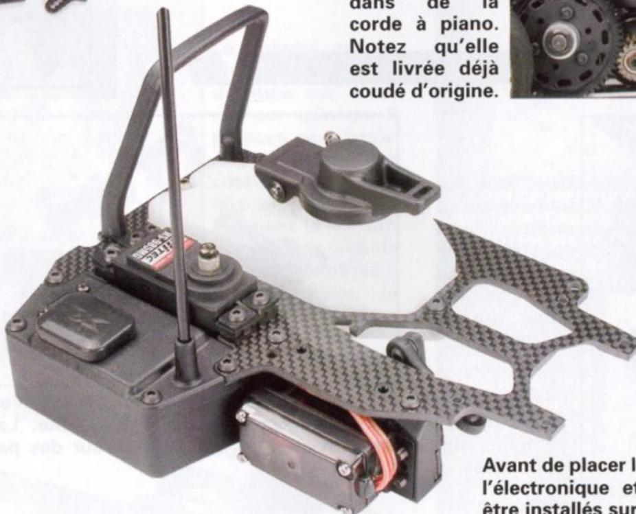
Avant de placer la platine sur le châssis, l'électronique et le réservoir doivent être installés sur cette dernière.
