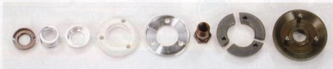
L'embrayage livré avec la NT1 est de type Centax, un attribut indispensable dans la discipline. Le volant est en aluminium et reçoit un traitement dur alors que l'écrou du volant et la bague fileté comprimant le ressort d'embrayage sont en acier et bénéficient du célèbre traitement Hudy.
