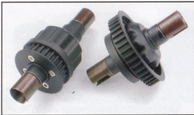
La XRay NT1 propose d'origine deux différentiels, l'arrière sera rempli de graisse silicone affichant 60000 cps et l'avant 80000 cps. Sachez que le différentiel avant peut être bloqué en remplaçant les pignons par une cale en plastique.
