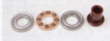
Comme la plupart des châssis piste de compétition, la NT1 dispose d'une butée à billes à l'extrémité de la cloche d'embrayage. C'est un élément fragile qu'il faut régulièrement surveiller. Enfin, ne pas oublier de mettre un peu de graisse sur les billes avant assemblage.
