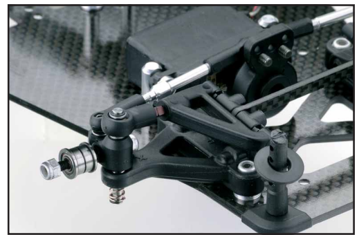
Die Turnbuckles an der Vorderachse bestehen nun aus Alu statt aus Federstahl.
