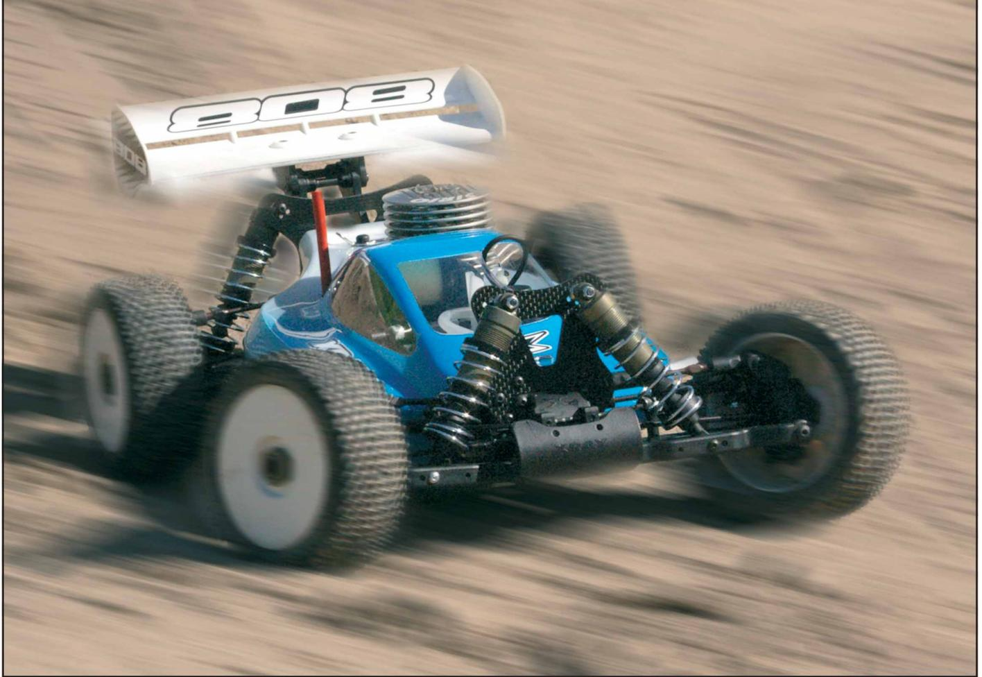
nung versorgt. Als Treibstoff verwenden wir Topsprit in der Mischung 25% Nitro + 2,5% Rizinus-Öl + 9,5% Synthetik-Öl + 63% Methanol.
